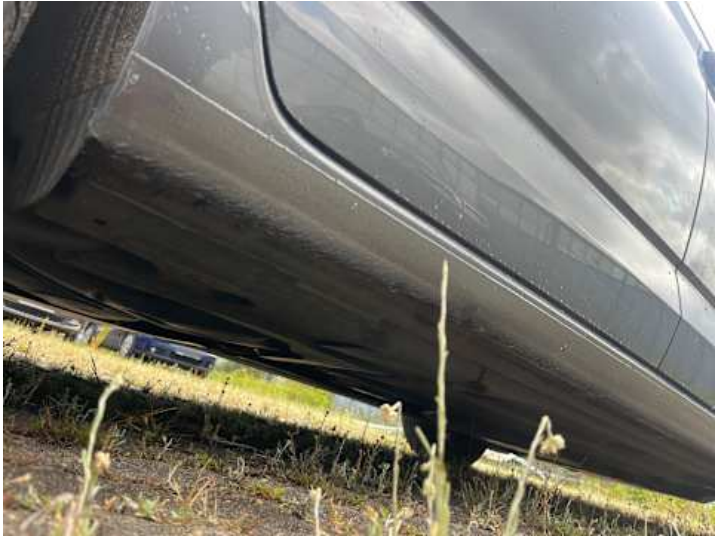
Schweller rechts (Verformung)
