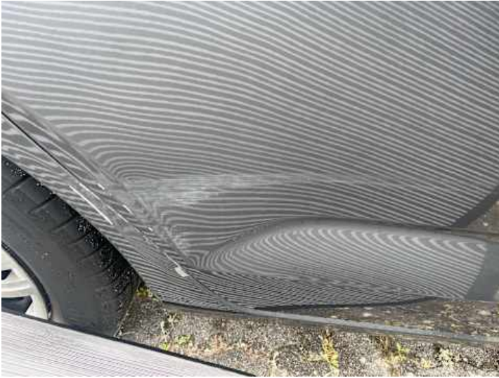
Türe hinten rechts (Verformung)
