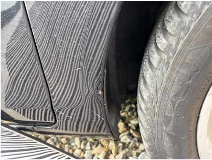
Kotflügel vorne rechts (Delle, Kratzer)
