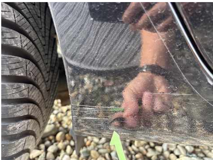
Schweller rechts (Kratzer)
