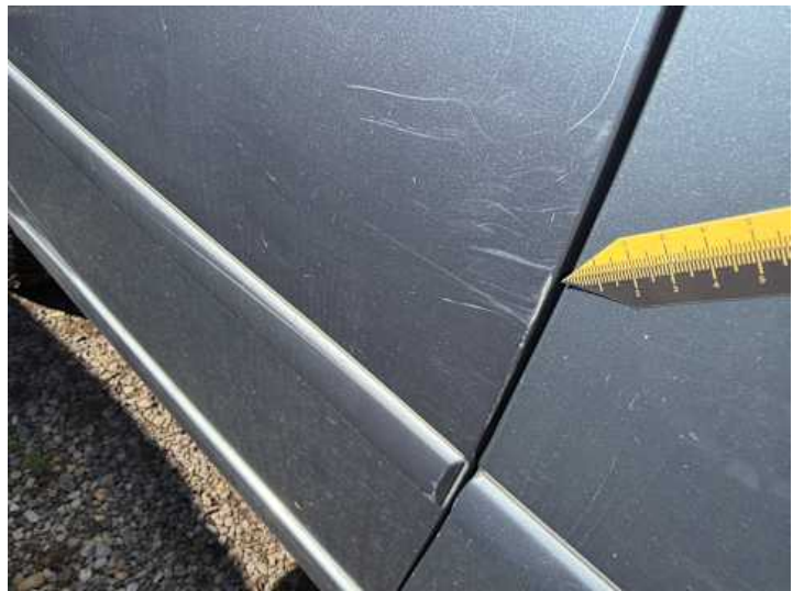
Türe hinten rechts (Kratzer)
