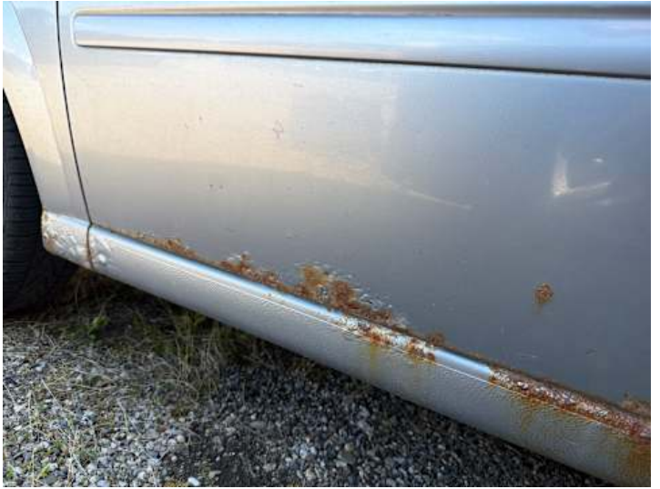
Fahrtür (Rost, Kratzer)
