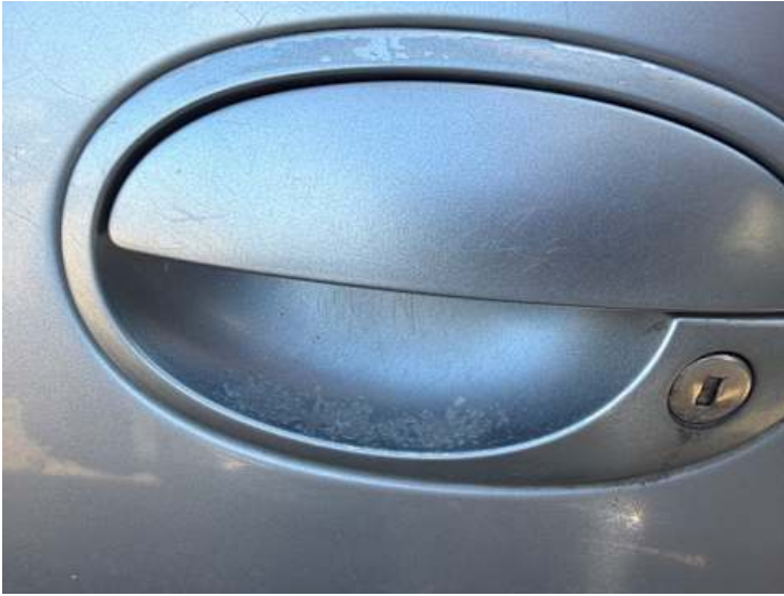
Fahrtür (Rost, Kratzer)
