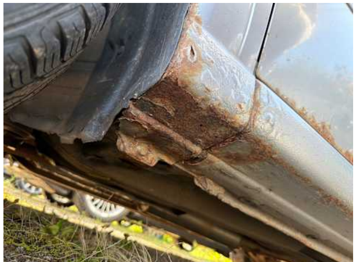
Schweller links (Rost)
