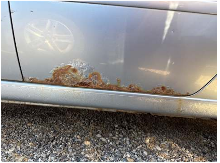
Türe hinten links (Rost)
