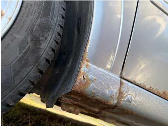
Kotflügel vorne links (Rost, Kratzer)
