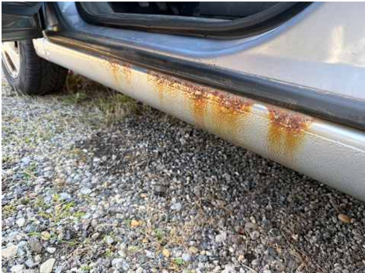
Schweller links (Rost)
