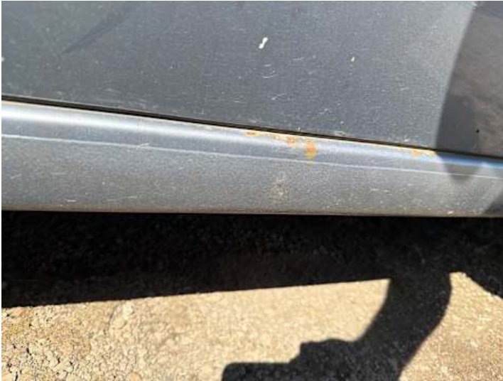
Schweller rechts (Rost)
