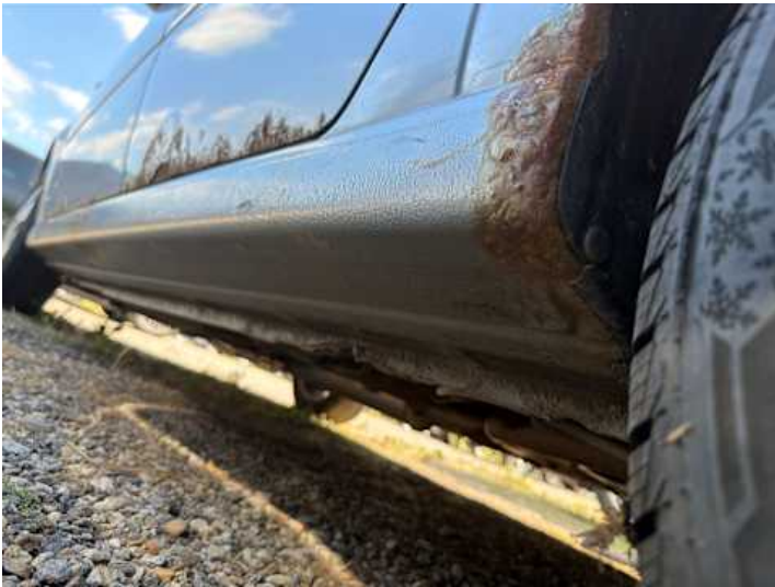
Schweller links (Rost)
