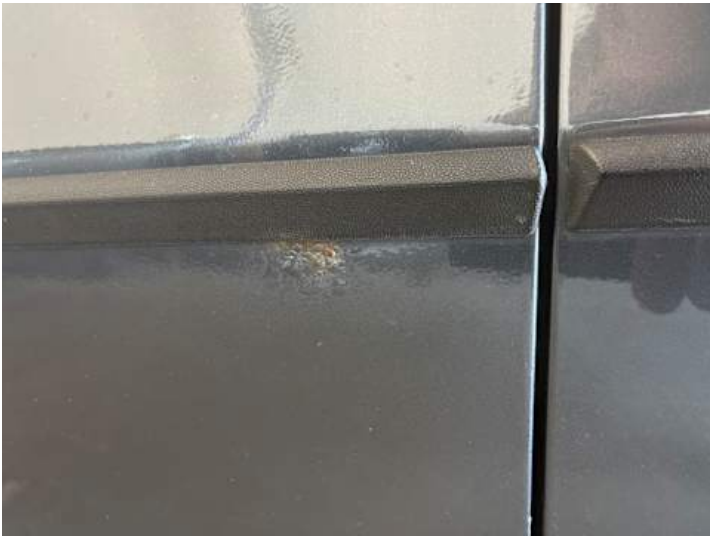
Fahrertür (Lackschaden, Rost)
