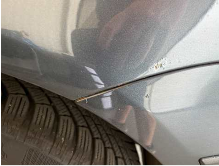
Seitenteil hinten links (Lackschaden, Rost)
