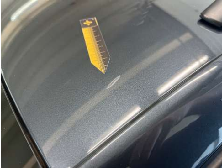
Dach (Kratzer, Lackschaden, Unsachgemäß instand gesetzt)
