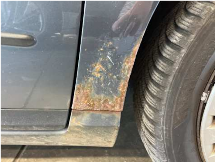
Kotflügel vorne rechts (Verformung, Lackschaden, Rost)
