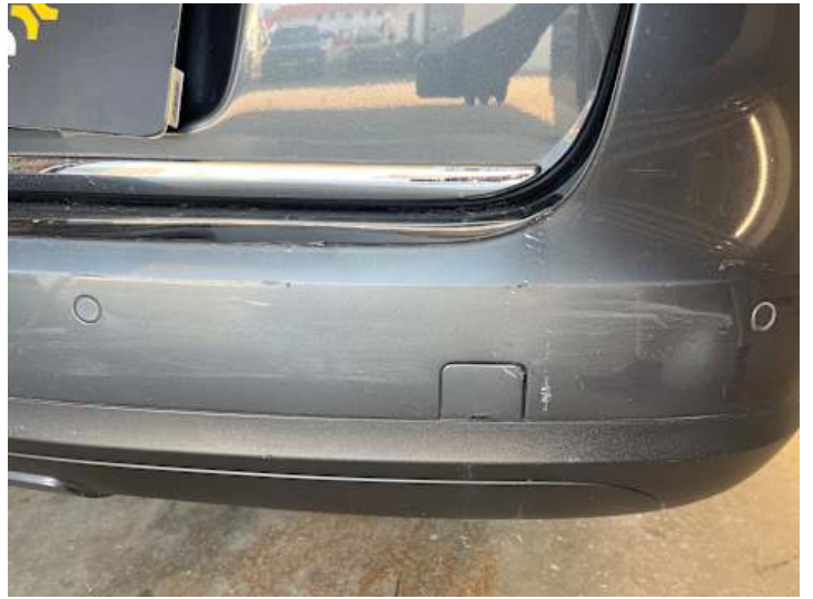
Stoßstange hinten (Kratzer, Lackschaden)
