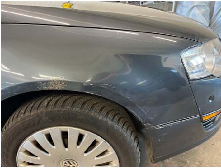
Kotflügel vorne rechts (Verformung, Lackschaden, Rost)
