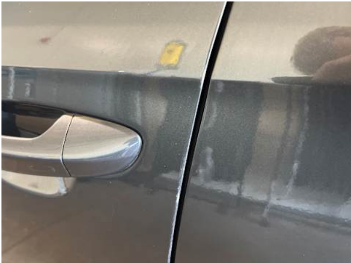
Fahrertür (Lackschaden, Rost)
