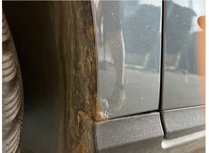
Kotflügel vorne links (Lackschaden, Rost)
