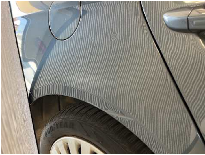
Seitenteil hinten rechts (Kratzer, Lackschaden, Delle, Rost)
