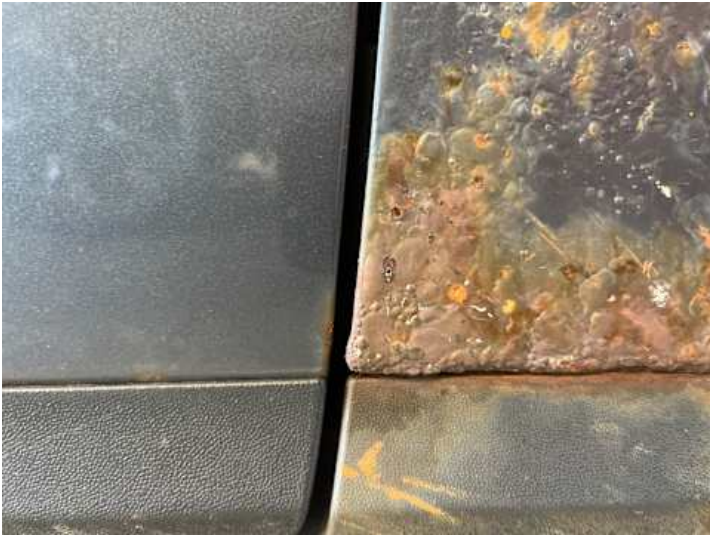
Beifahrertür (Lackschaden, Rost, Kratzer)
