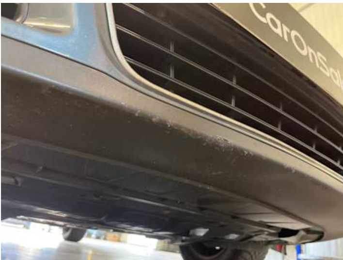
Stoßstange vorne (Kratzer, Lackschaden)
