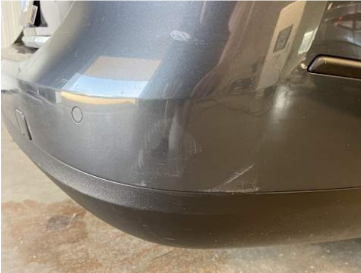
Stoßstange hinten (Kratzer, Lackschaden)
