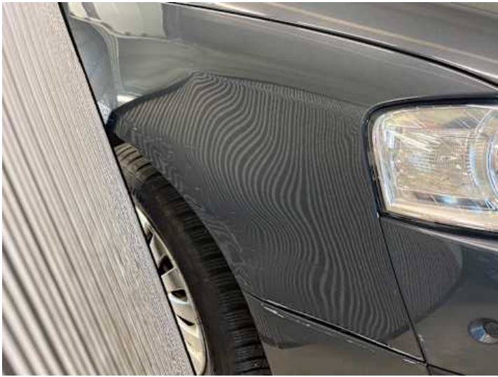
Kotflügel vorne rechts (Verformung, Lackschaden, Rost)
