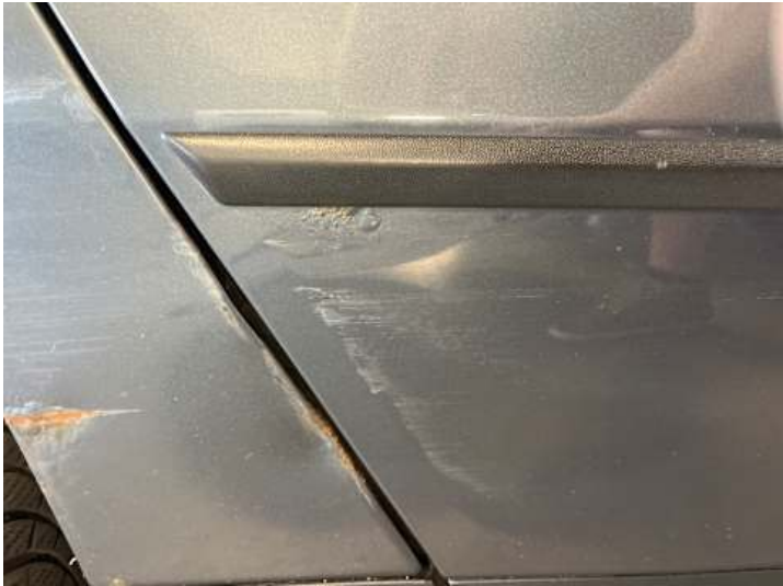
Türe hinten rechts (Delle, Lackschaden, Verformung, Rost)
