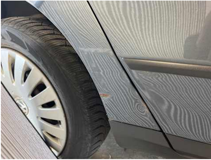
Seitenteil hinten rechts (Kratzer, Lackschaden, Delle, Rost)
