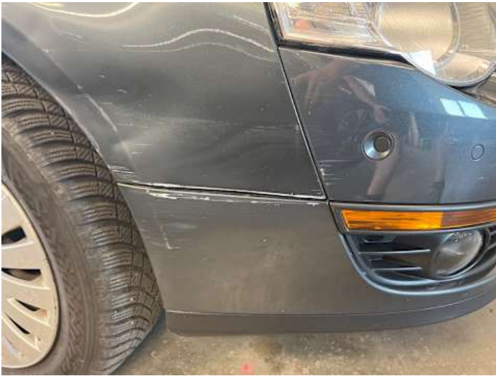
Stoßstange vorne (Kratzer, Lackschaden)
