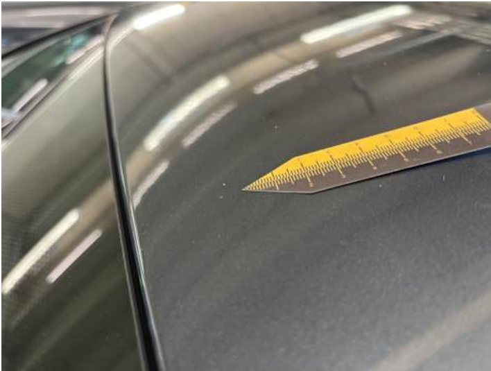
Dach (Steinschlag, Rost)
