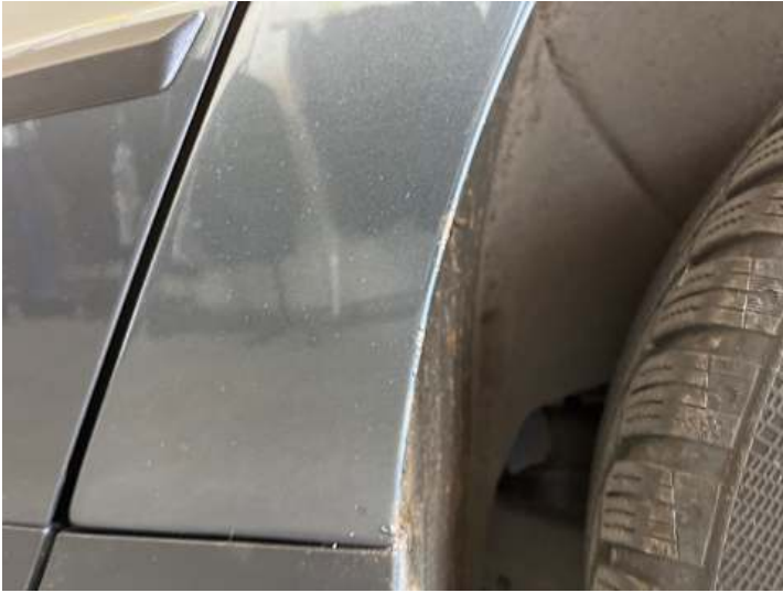
Seitenteil hinten links (Lackschaden, Rost)
