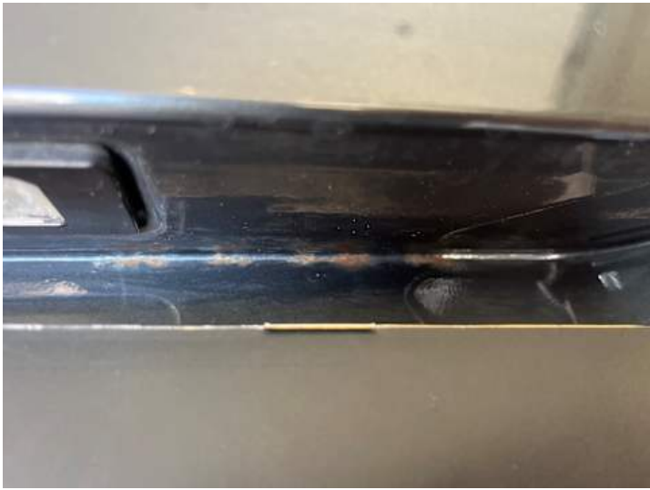
Heckklappe (Rost, Lackschaden)
