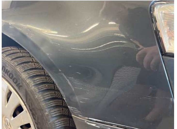
Kotflügel vorne rechts (Verformung, Lackschaden, Rost)
