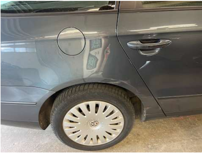
Seitenteil hinten rechts (Kratzer, Lackschaden, Delle, Rost)
