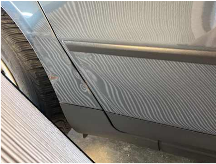
Türe hinten rechts (Delle, Lackschaden, Verformung, Rost)
