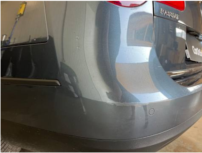
Stoßstange hinten (Kratzer, Lackschaden)
