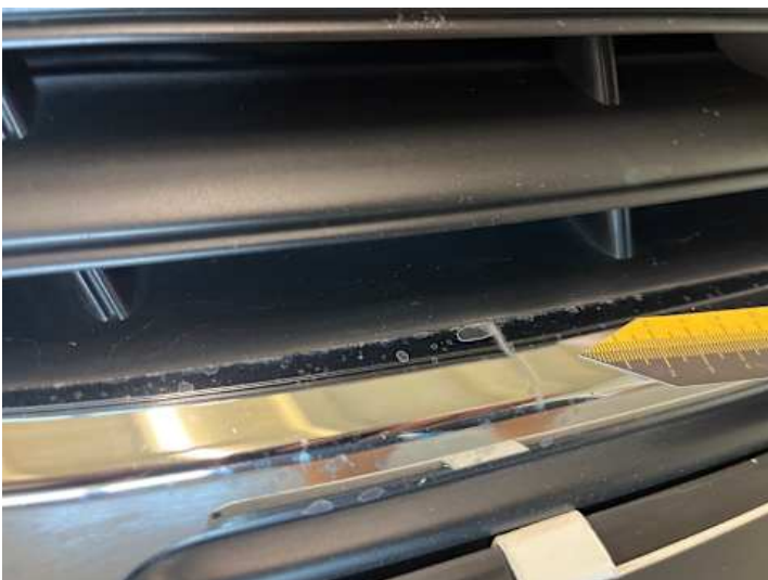
Stoßstange vorne (Riss/Bruch)
