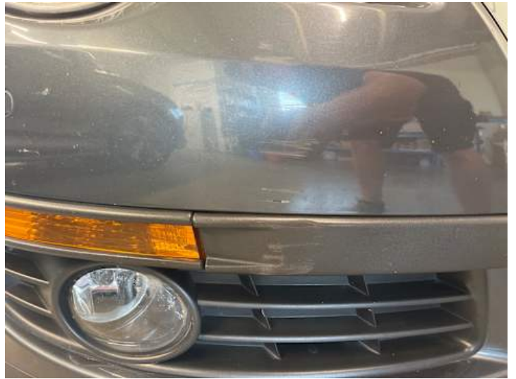
Stoßstange vorne (Kratzer, Lackschaden)
