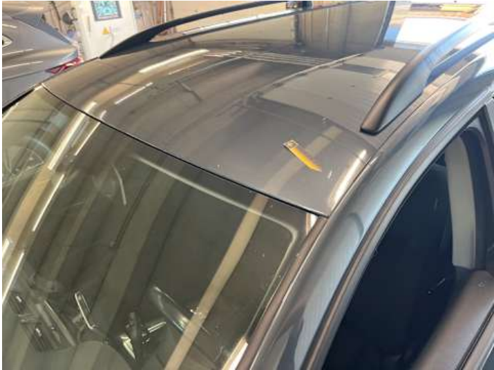
Dach (Kratzer, Lackschaden, Unsachgemäß instand gesetzt)
