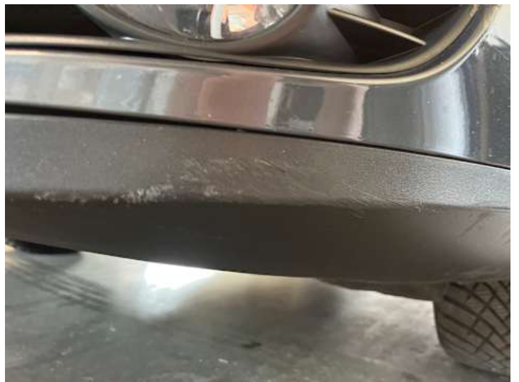
Stoßstange vorne (Kratzer, Lackschaden)
