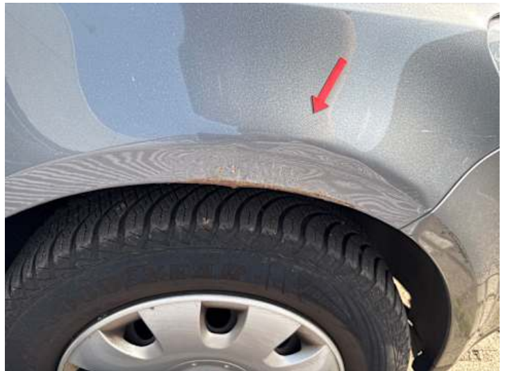
Kotflügel vorne rechts (Verformung, Rost)
