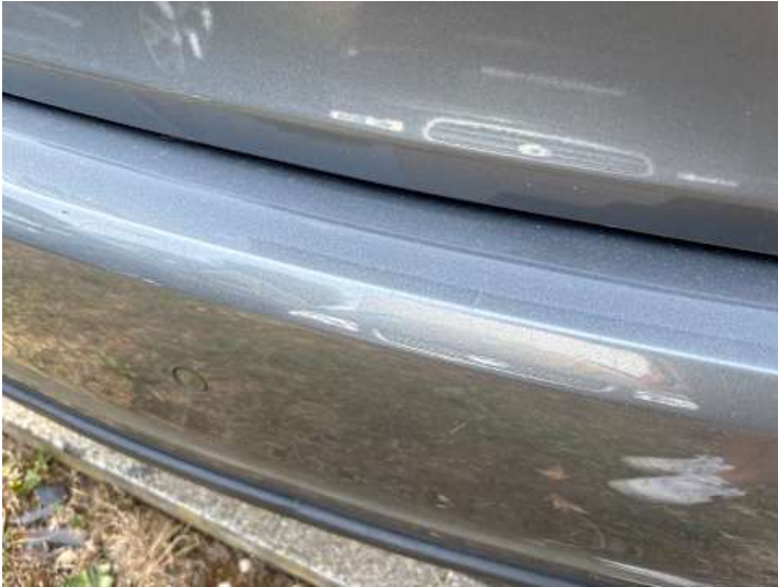
Stoßstange hinten (Lackschaden, Kratzer)
