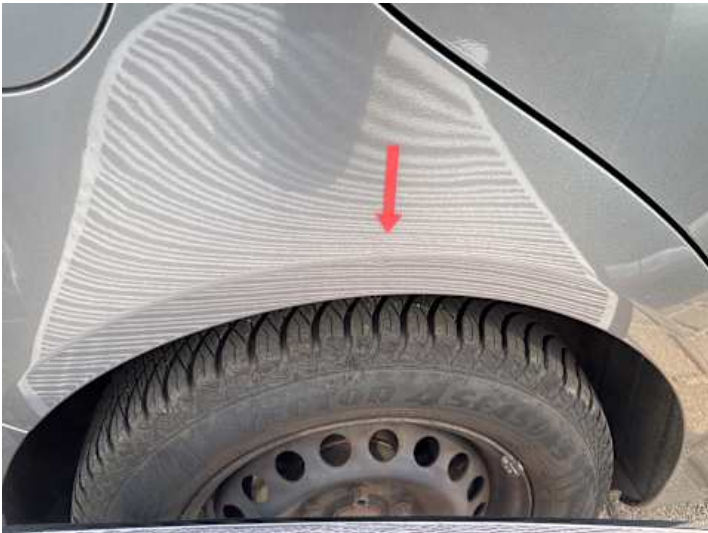
Seitenteil hinten rechts (Delle)
