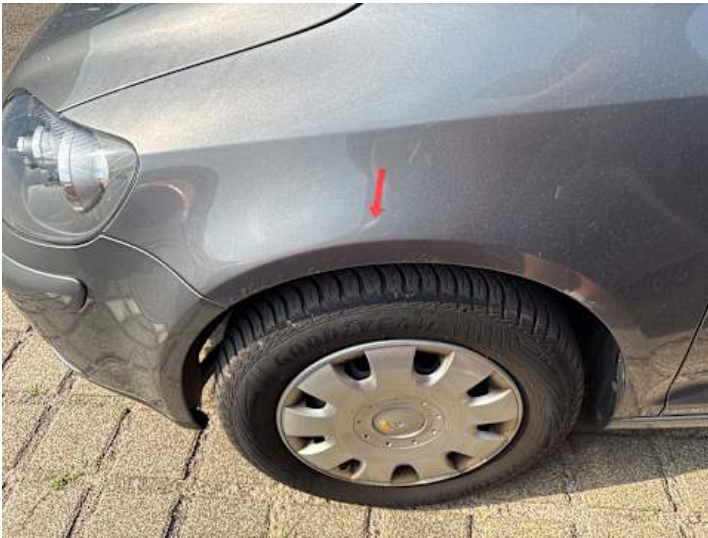
Kotflügel vorne links (Rost)
