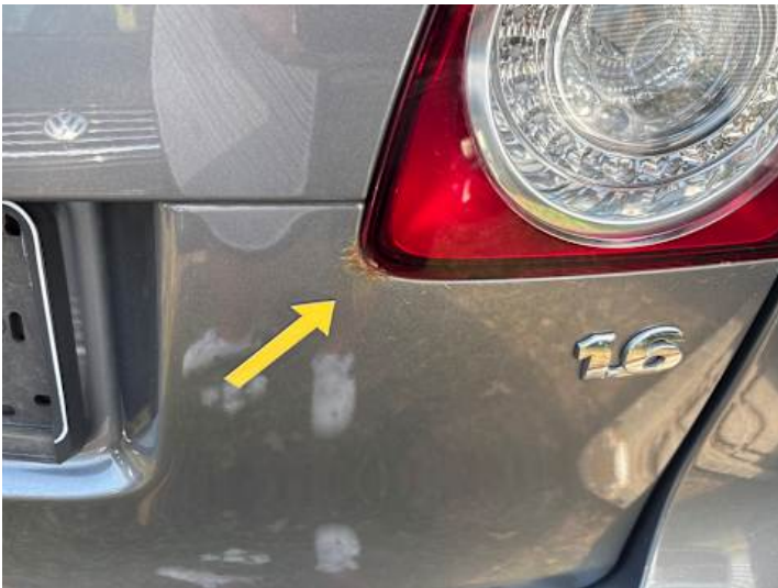
Heckklappe (Rost, Lackschaden)
