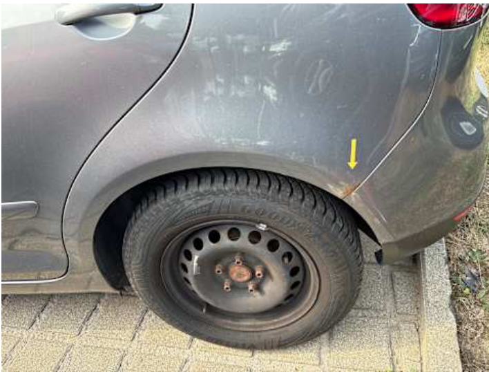
Seitenteil hinten links (Rost)
