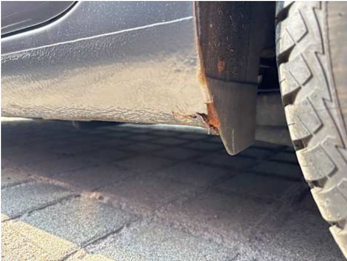
Schweller links (Rost)
