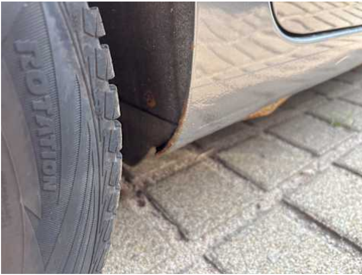
Schweller rechts (Rost, Verformung)
