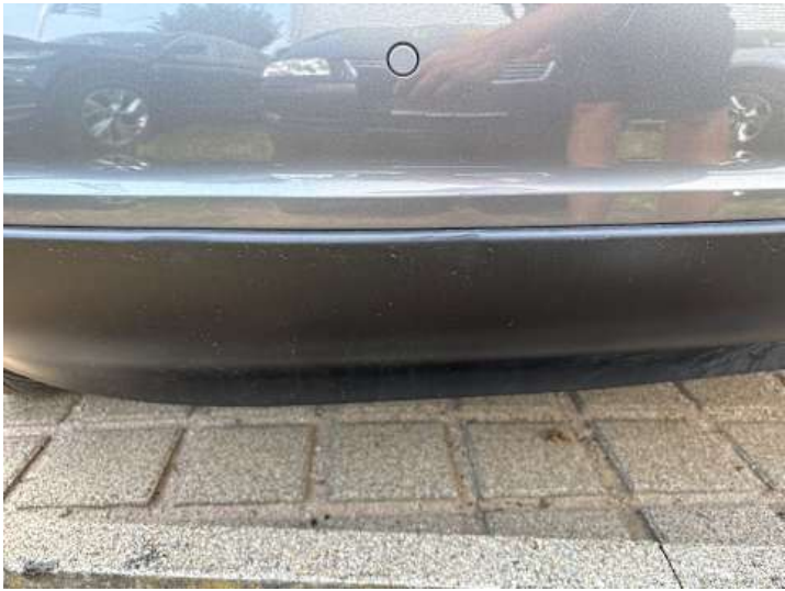
Stoßstange hinten (Lackschaden, Kratzer)
