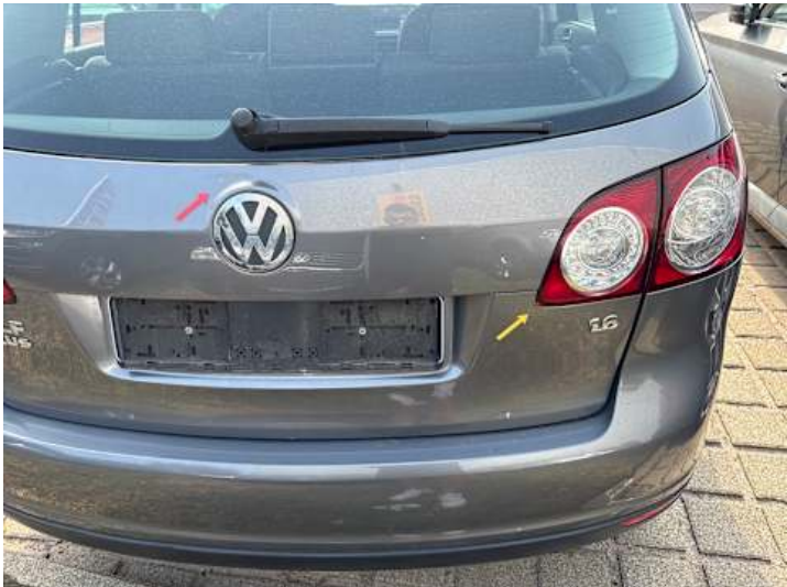
Heckklappe (Rost, Lackschaden)
