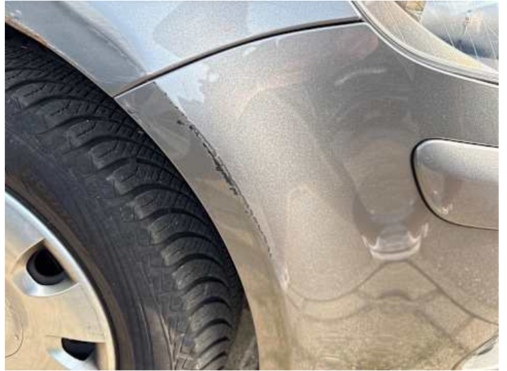
Stoßstange vorne (Kratzer, Lackschaden)
