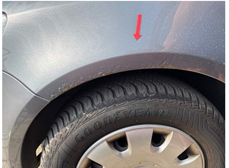
Kotflügel vorne links (Rost)
