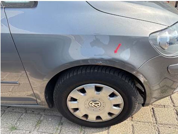
Kotflügel vorne rechts (Verformung, Rost)
