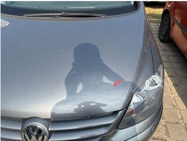
Motorhaube (Delle, Lackschaden)
