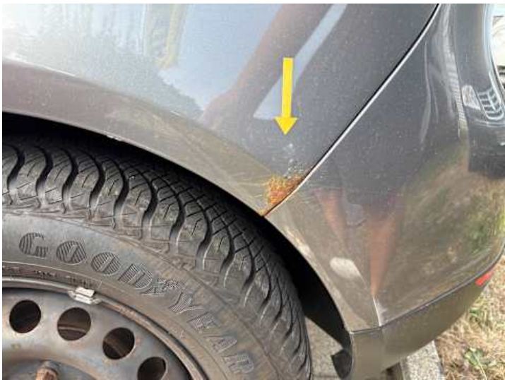
Seitenteil hinten links (Rost)
