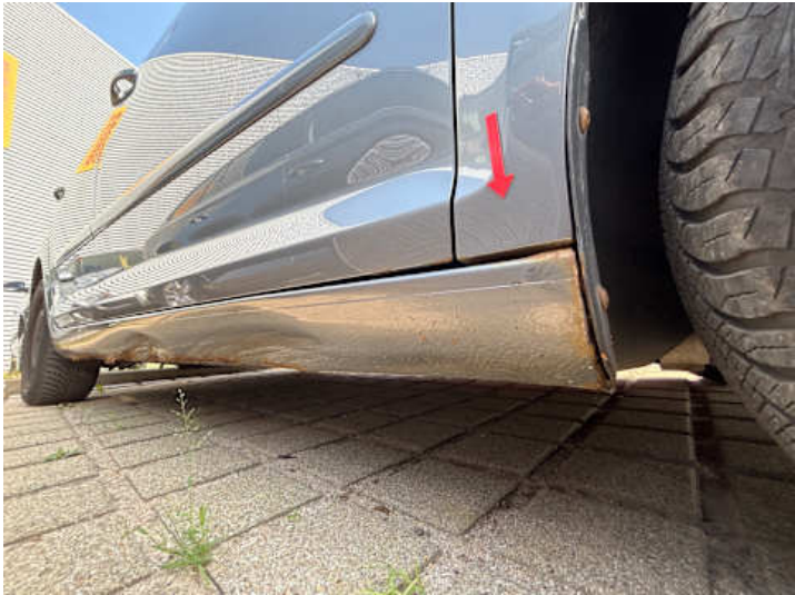
Schweller rechts (Rost, Verformung)
