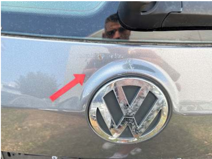
Heckklappe (Rost, Lackschaden)
