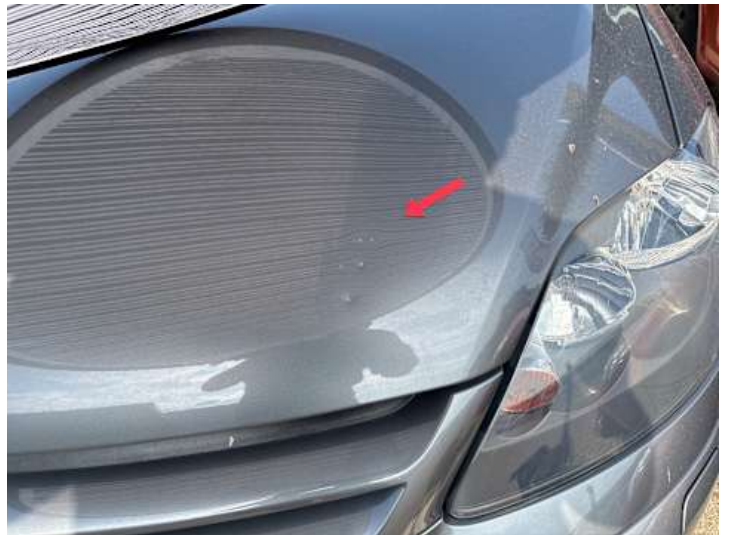
Motorhaube (Delle, Lackschaden)
