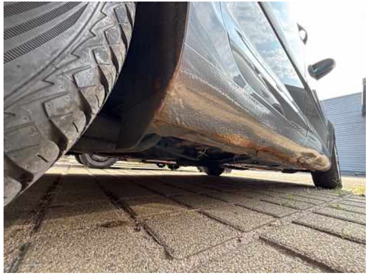
Schweller rechts (Rost, Verformung)
