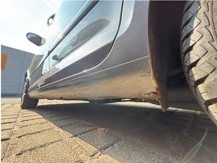
Schweller links (Rost)
