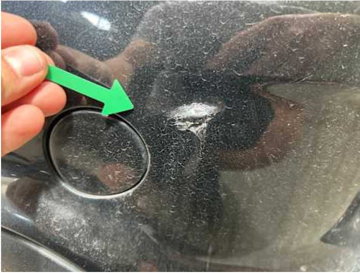
Stoßstange hinten (Kratzer, Verformung, Riss/Bruch)
