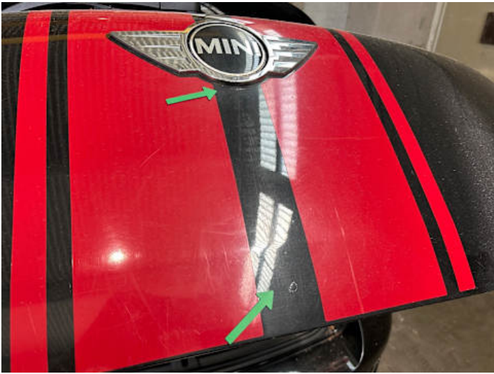
Heckklappe (Rost, Kratzer)
