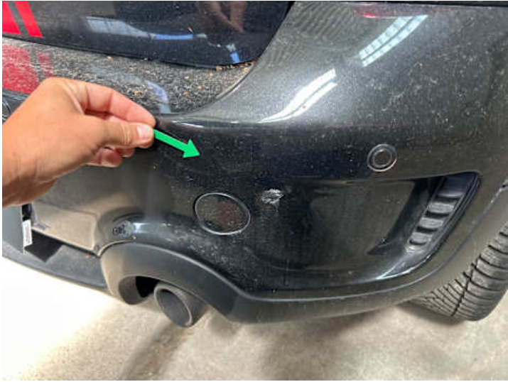
Stoßstange hinten (Kratzer, Verformung, Riss/Bruch)
