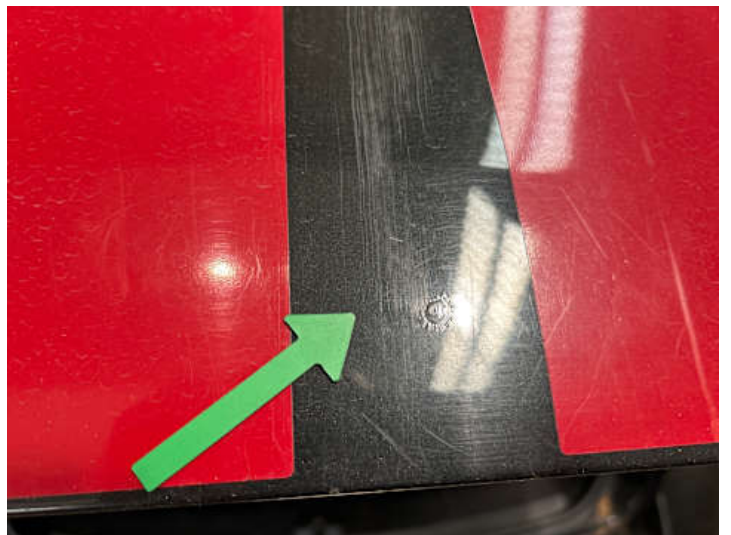
Heckklappe (Rost, Kratzer)
