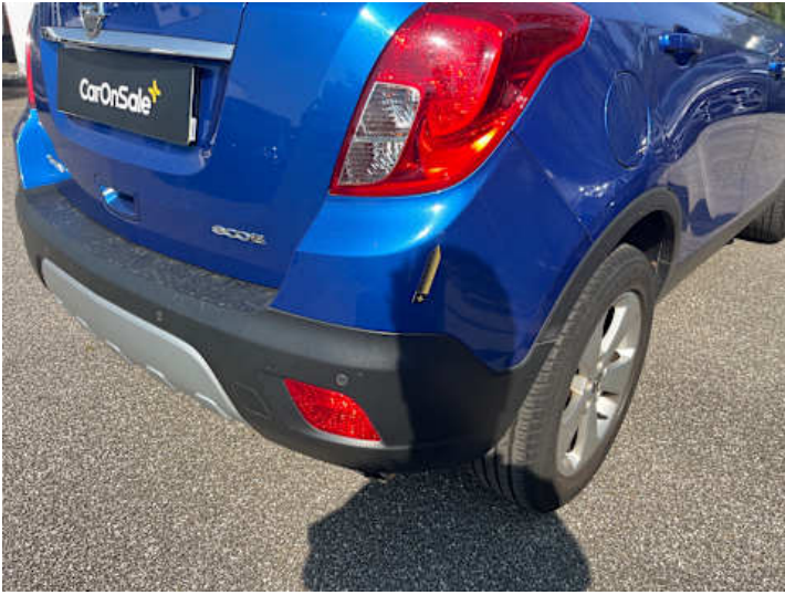
Stoßstange hinten (Kratzer, Lackschaden)
