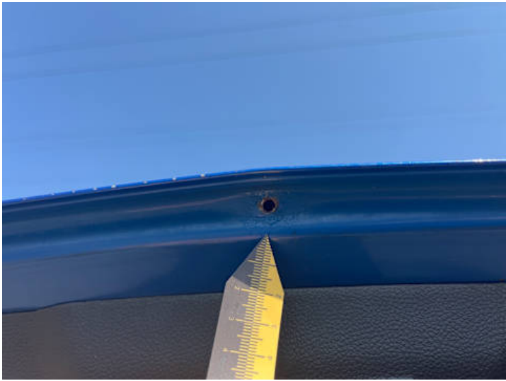
Heckklappe (Rost, Lackschaden)
