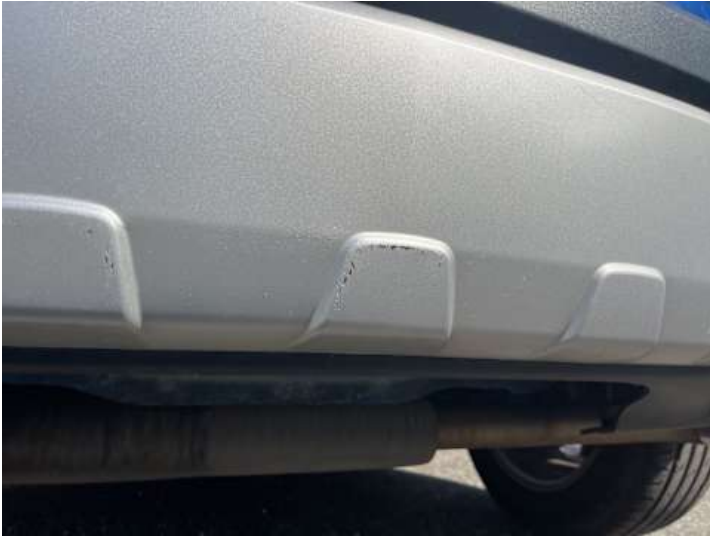
Stoßstange hinten (Kratzer, Lackschaden)
