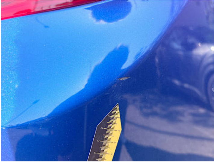
Stoßstange hinten (Kratzer, Lackschaden)
