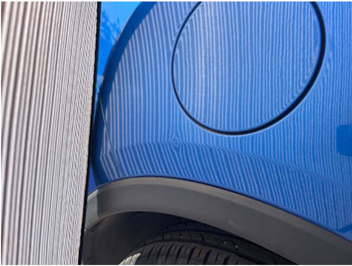
Seitenteil hinten rechts (Delle)
