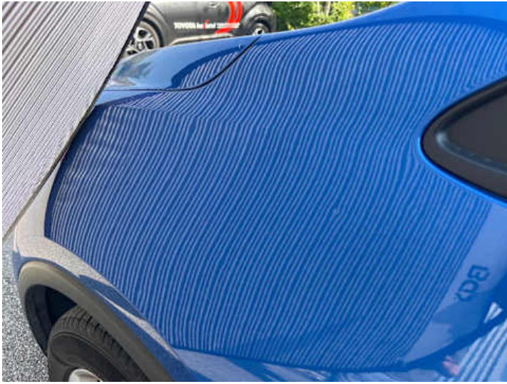
Kotflügel vorne links (Delle)
