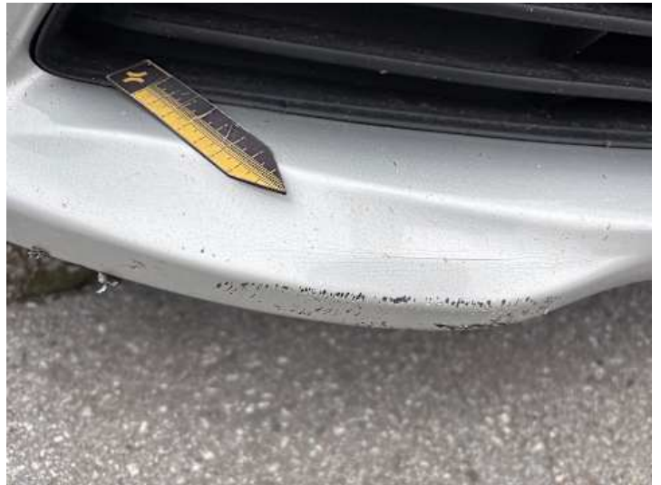
Stoßstange vorne (Kratzer, Riss/Bruch)
