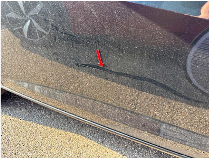
Fahrtür (Lackschaden, Kratzer)
