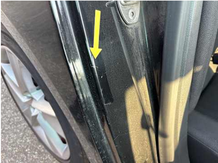
Schweller rechts (Lackschaden)
