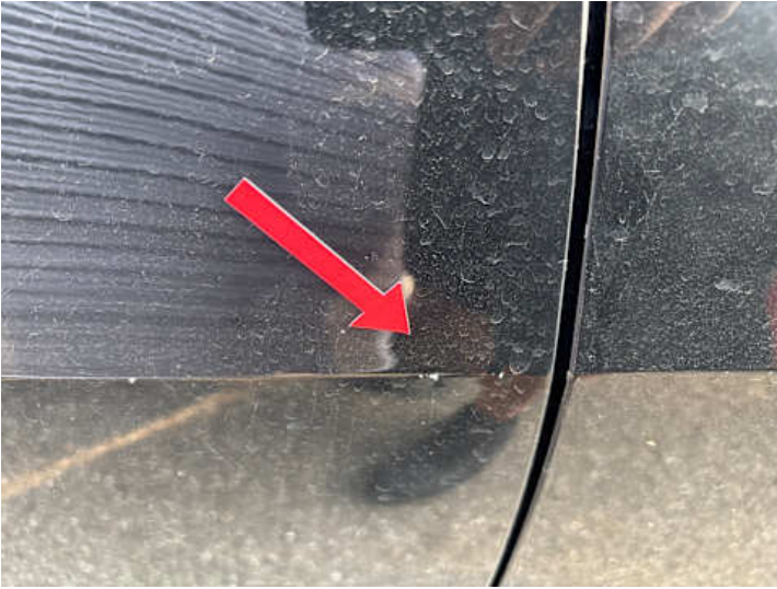
Türe hinten rechts (Lackschaden, Delle)
