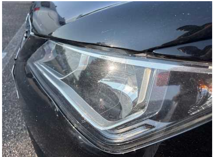
Scheinwerfer (links) (Anderer Schaden, Steinschlag): Porös
