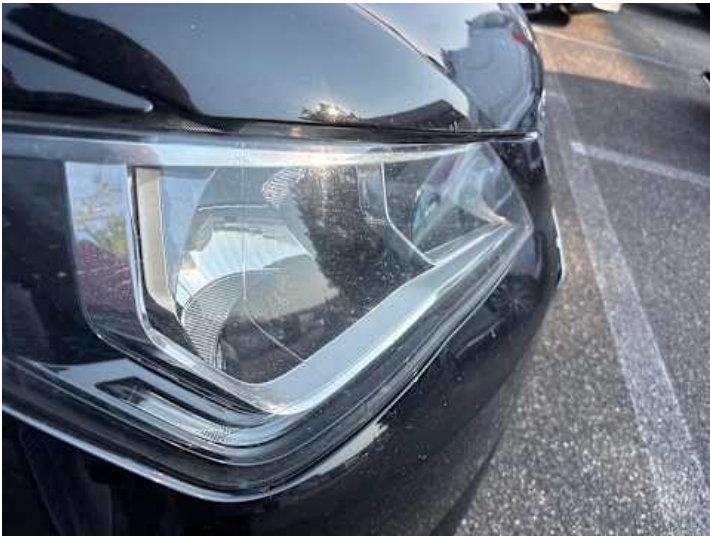
Scheinwerfer (rechts) (Anderer Schaden, Steinschlag): Porös
