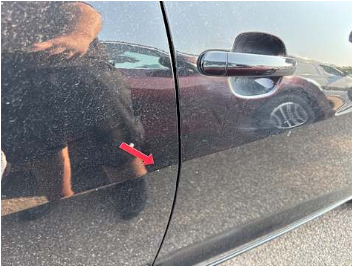
Türe hinten rechts (Lackschaden, Delle)
