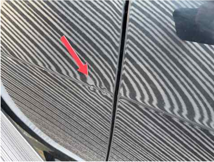
Türe hinten rechts (Lackschaden, Delle)
