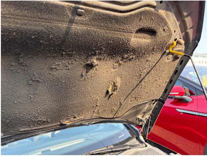
Motorhaube (Anderer Schaden): Dämmung
