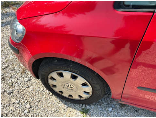
Kotflügel vorne links (Unsachgemäß instand gesetzt)
