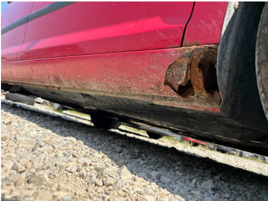
Schweller rechts (Rost)
