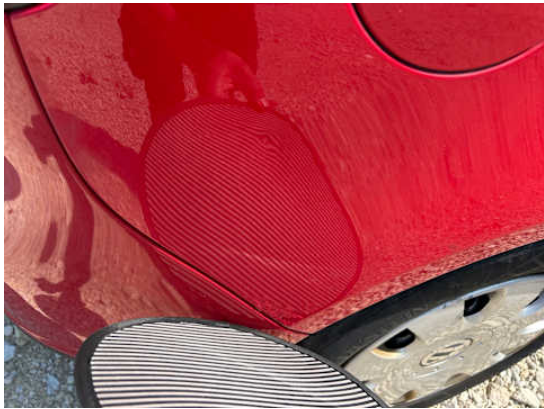
Seitenteil hinten rechts (Rost, Delle)
