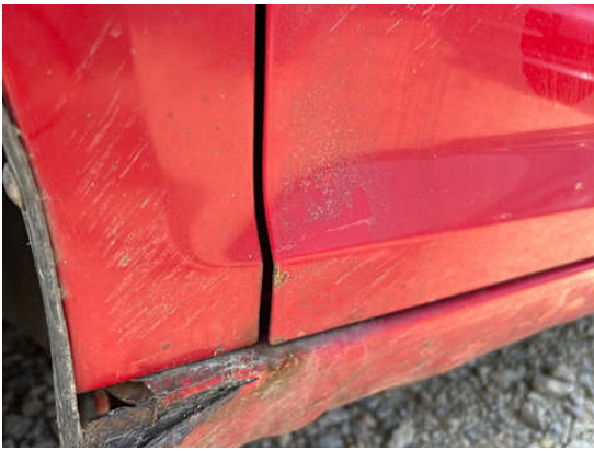
Fahrertür (Kratzer, Rost)
