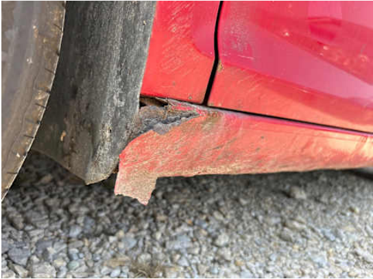
Schweller links (Rost)
