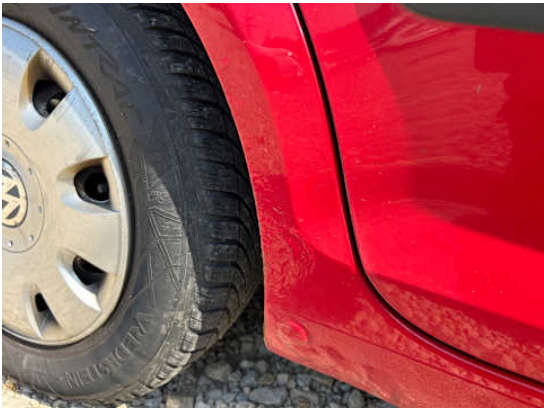
Seitenteil hinten rechts (Rost, Delle)
