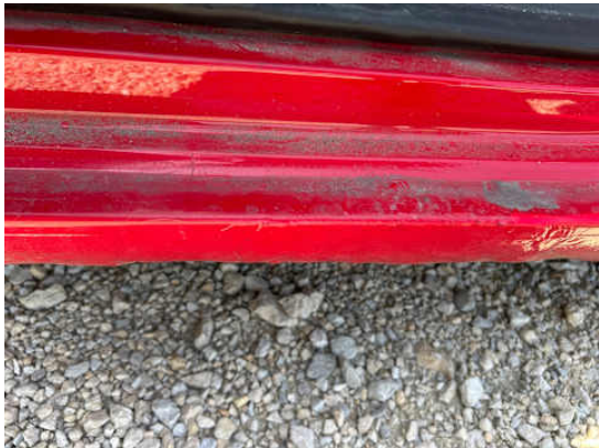
Schweller links (Rost)
