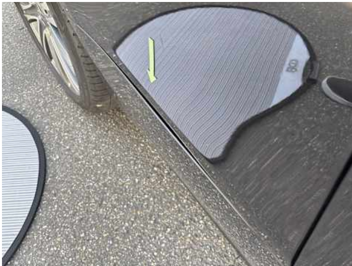
Seitenteil hinten rechts (Spaltmaße ungenau)
