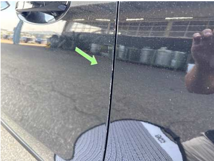
Fahrtür (Kratzer, Delle)
