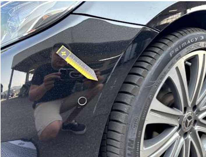
Stoßstange vorne (Kratzer)
