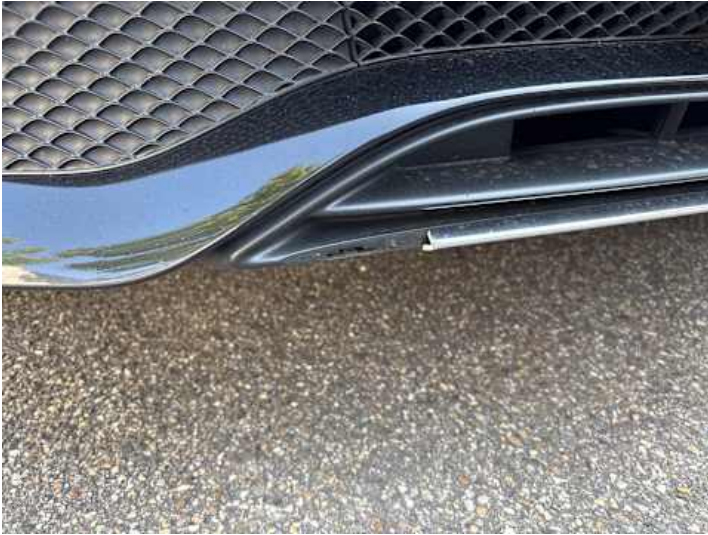
Stoßstange vorne (Riss/Bruch)
