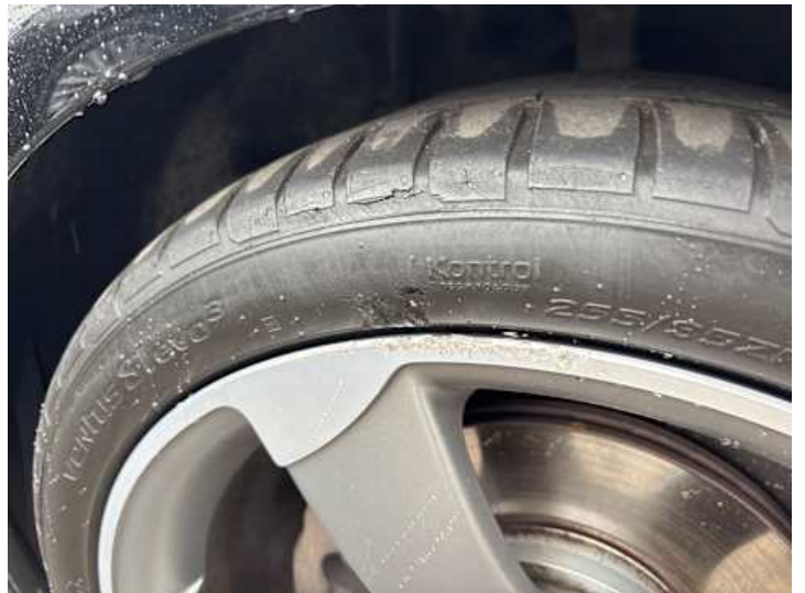
Rad (Kratzer, Riss/Bruch)
