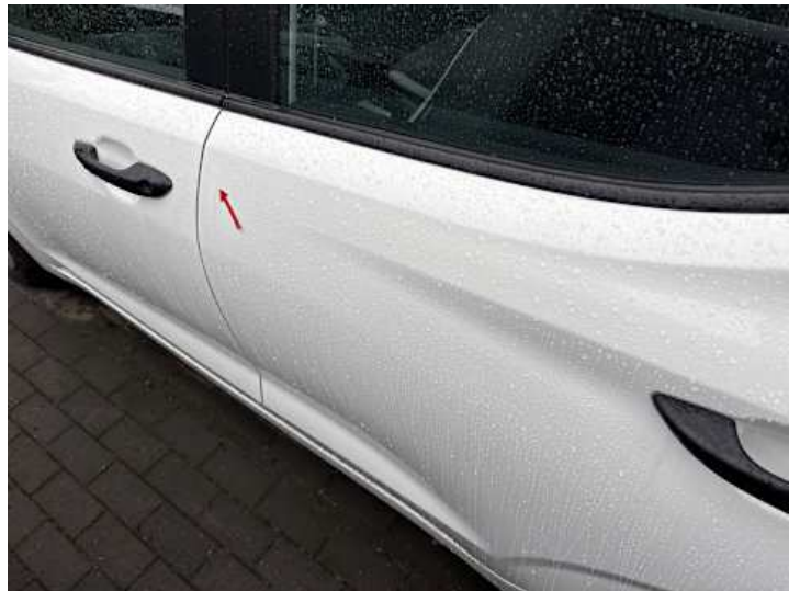
Türe hinten links (Kratzer)
