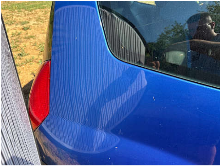
Seitenteil hinten rechts (Delle, Kratzer, Lackschaden)
