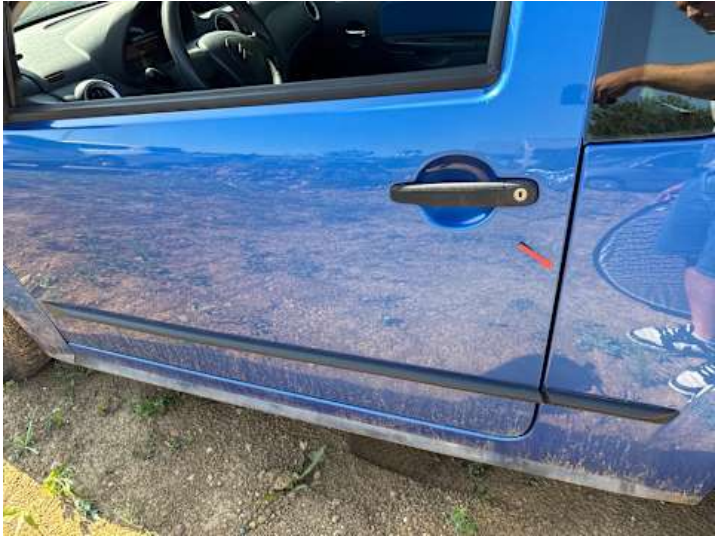
Fahrtür (Lackschaden, Rost)
