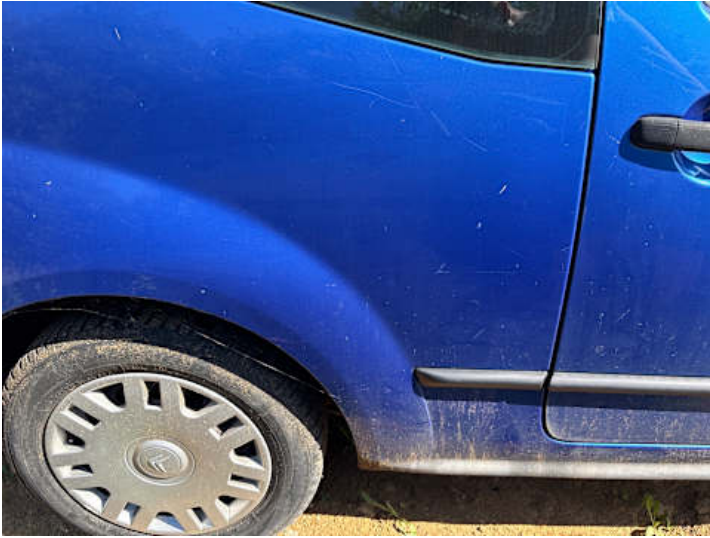
Seitenteil hinten rechts (Delle, Kratzer, Lackschaden)
