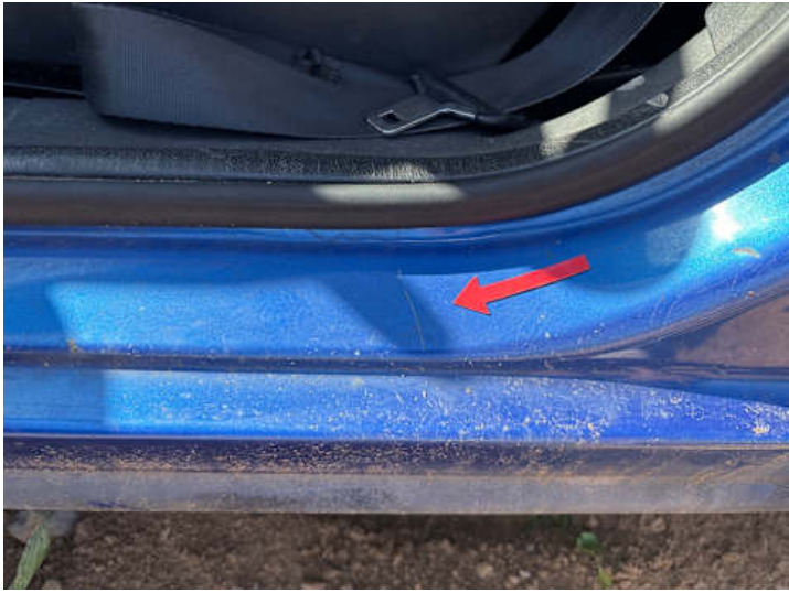
Fahrtür (Lackschaden, Spaltmaße ungenau)
