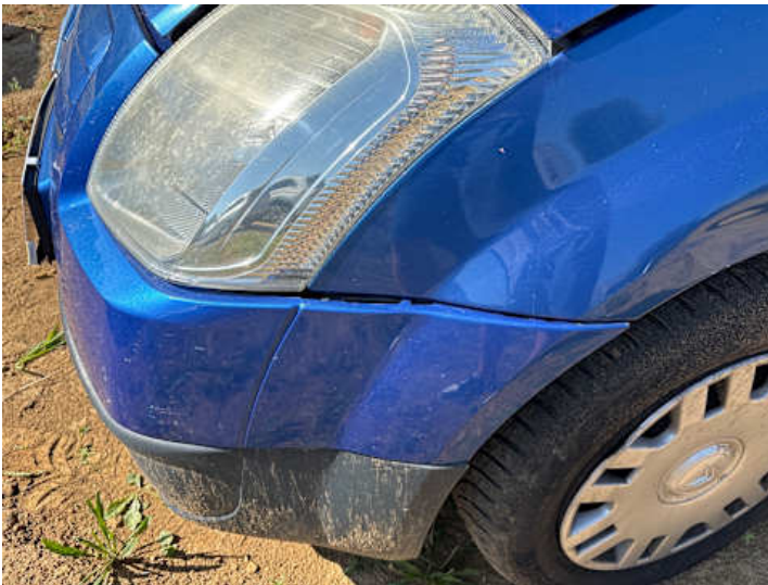
Stoßstange vorne (Spaltmaße ungenau)
