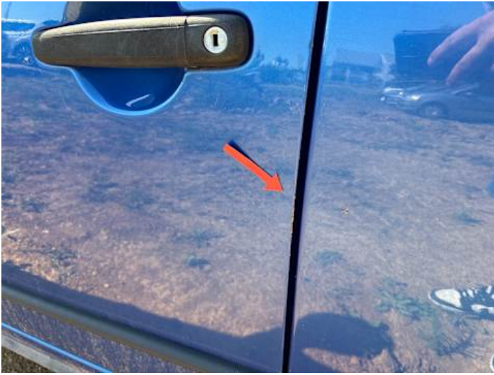
Fahrtür (Lackschaden, Rost)
