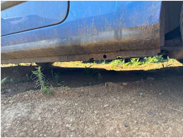
Schweller links (Rost)
