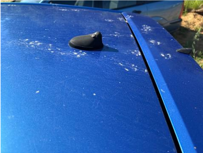
Dach (Ausgeblichen/Matt, Anderer Schaden): Antenne fehlt
