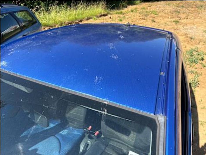
Dach (Ausgeblichen/Matt, Anderer Schaden): Antenne fehlt
