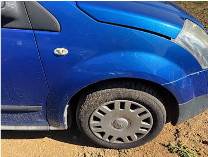
Kotflügel vorne rechts (Kratzer, Lackschaden)
