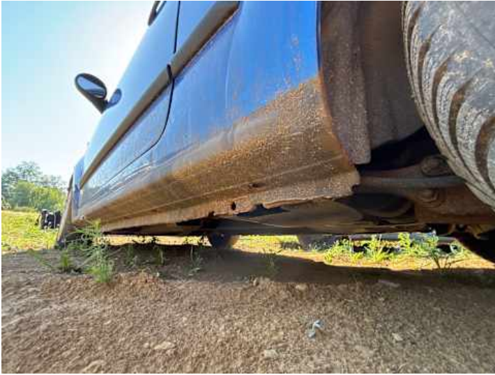
Schweller links (Rost)
