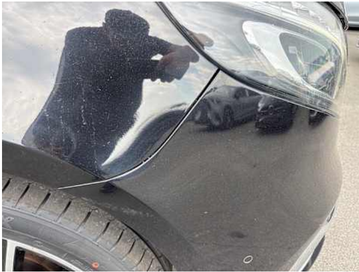
Stoßstange vorne (Spaltmaße ungenau)
