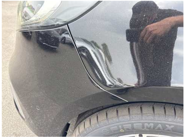
Stoßstange vorne (Spaltmaße ungenau)
