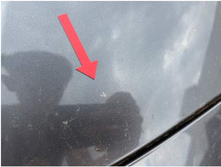
Motorhaube (Steinschlag, Lackschaden)
