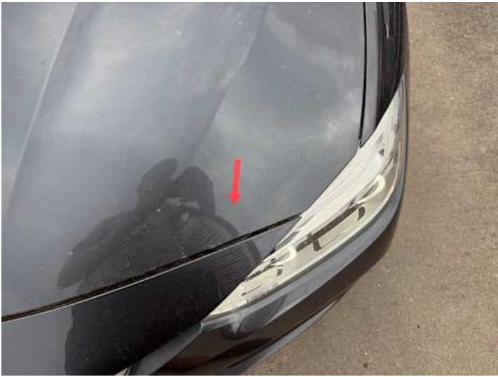
Motorhaube (Steinschlag, Lackschaden)
