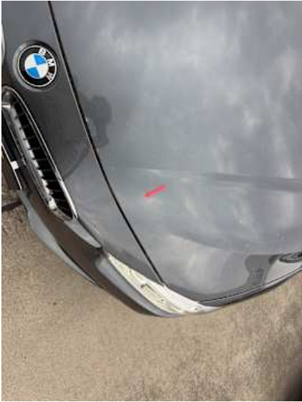
Motorhaube (Steinschlag, Lackschaden)
