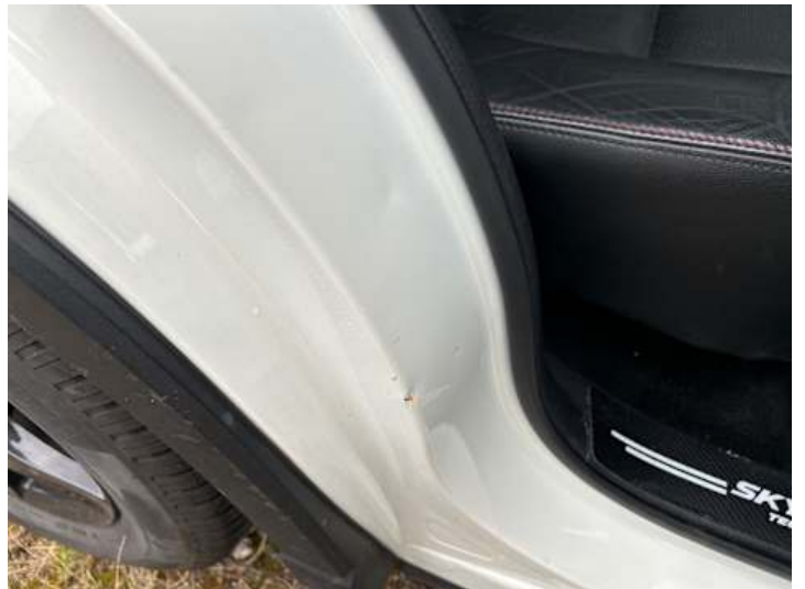
Schweller links (Kratzer, Verformung, Rost)
