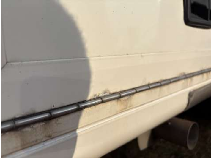
Seitenteil hinten links (Lackschaden)
