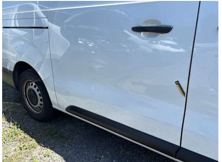
Türe hinten rechts (Rost, Lackschaden)
