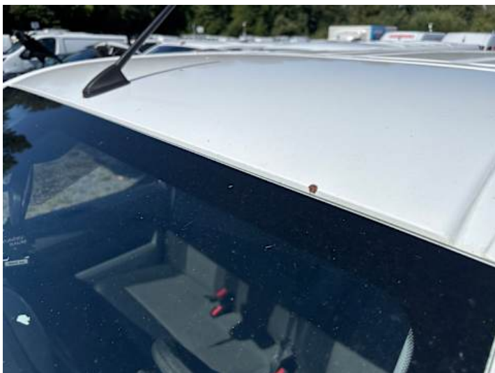
Dach (Steinschlag, Lackschaden, Rost)
