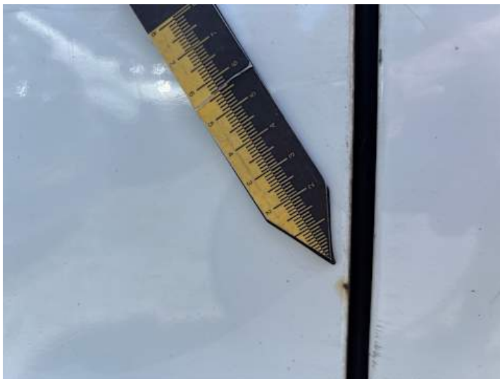
Türe hinten rechts (Rost, Lackschaden)
