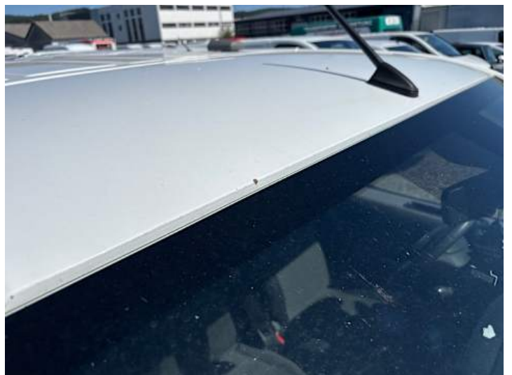
Dach (Steinschlag, Lackschaden, Rost)
