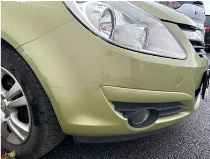
Stoßstange vorne (Lackschaden)
