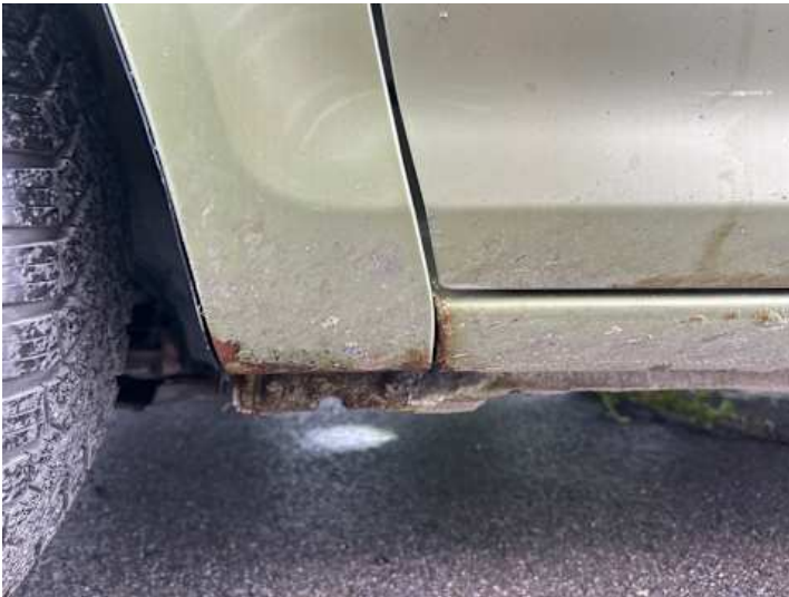
Schweller links (Rost)
