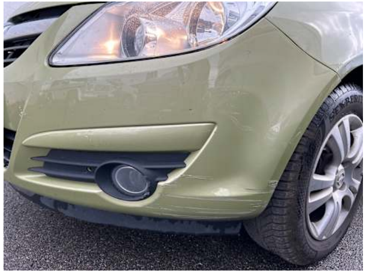
Stoßstange vorne (Lackschaden)
