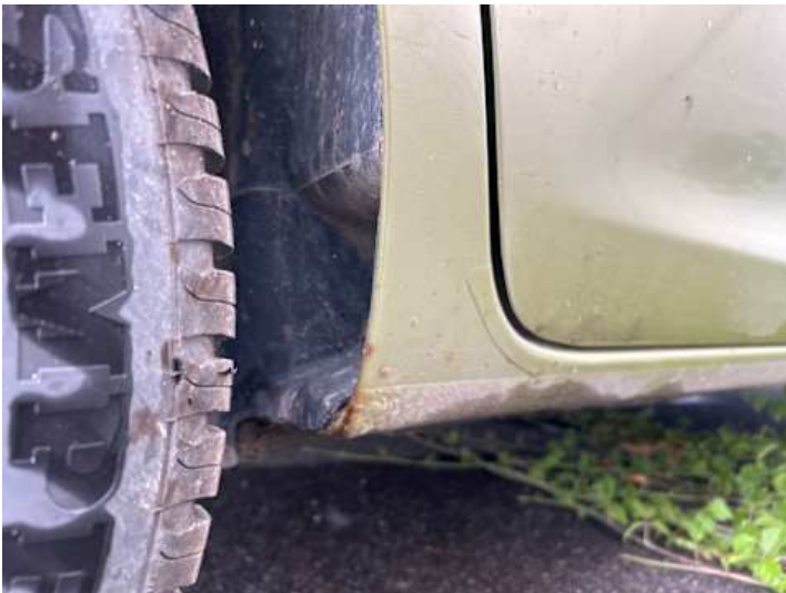
Schweller rechts (Rost)
