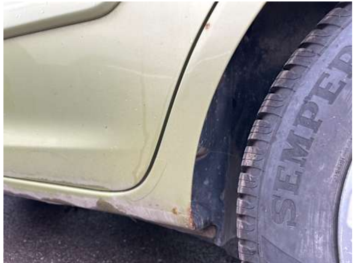
Schweller links (Rost)
