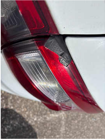
Rücklicht (rechts) (Riss/Bruch)
