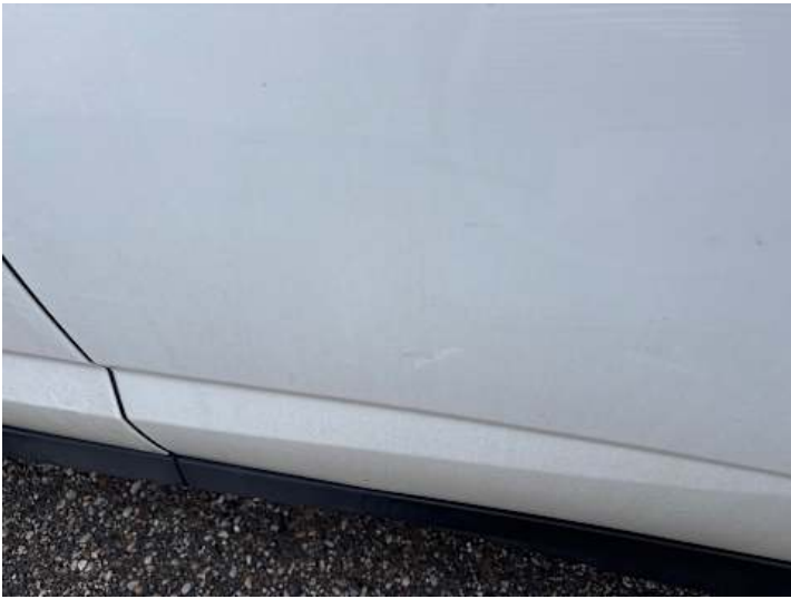
Türe hinten links (Kratzer, Lackschaden)
