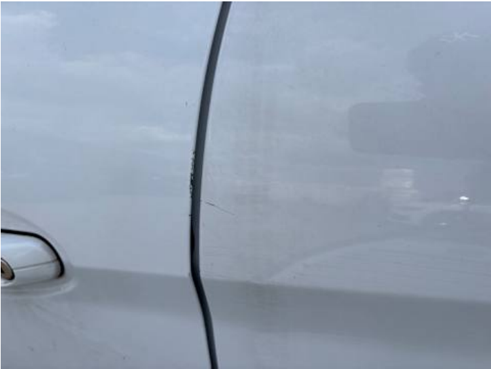
Türe hinten links (Kratzer, Lackschaden)
