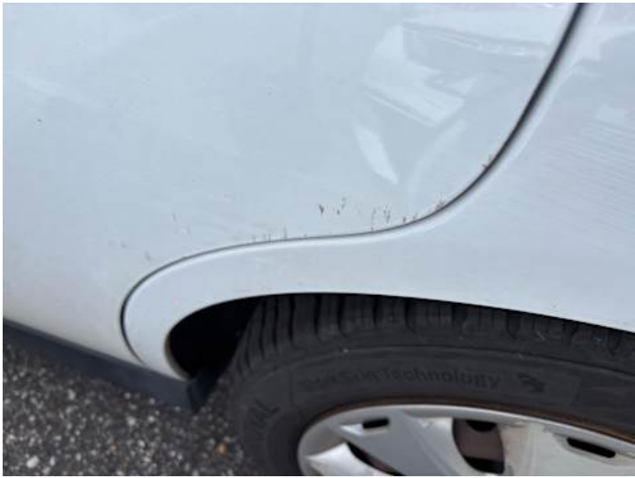
Türe hinten links (Kratzer, Lackschaden)
