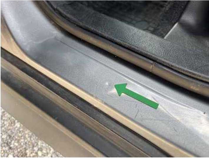
Schweller links (Kratzer, Delle)
