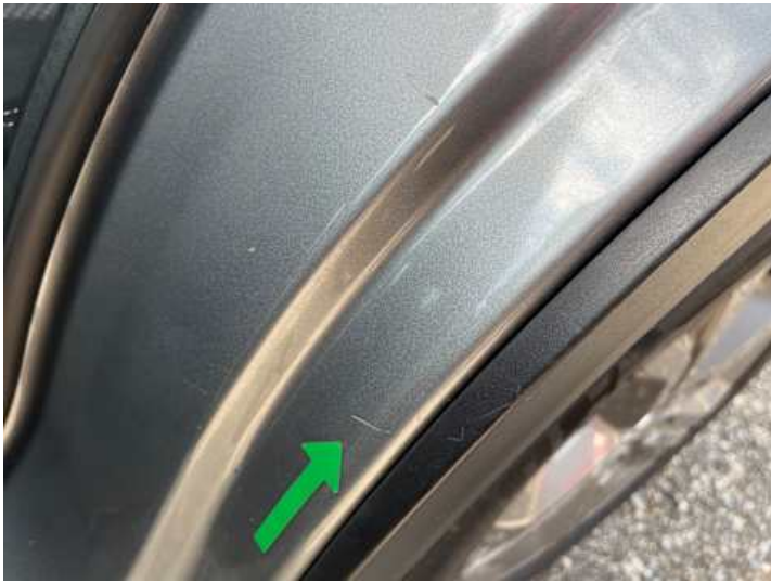
Schweller links (Kratzer, Delle)
