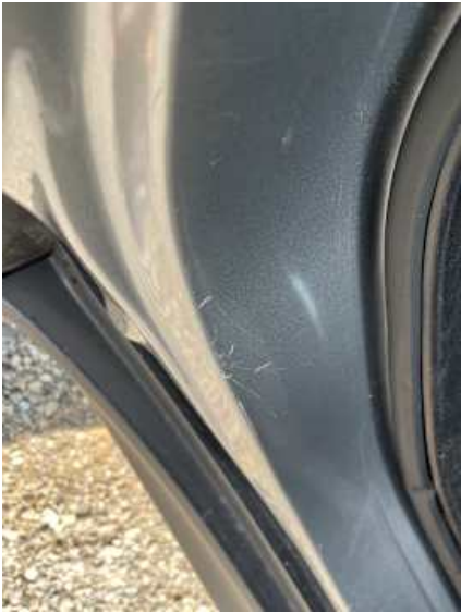
Schweller rechts (Kratzer)
