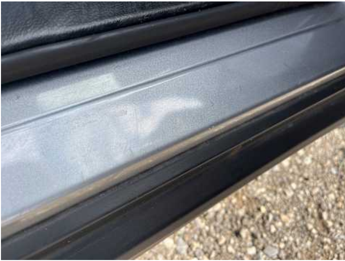
Schweller rechts (Delle, Kratzer)
