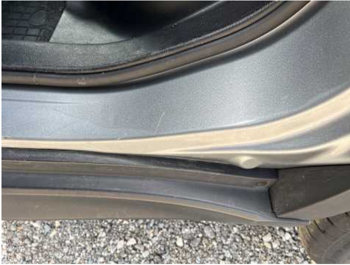
Schweller links (Kratzer, Delle)
