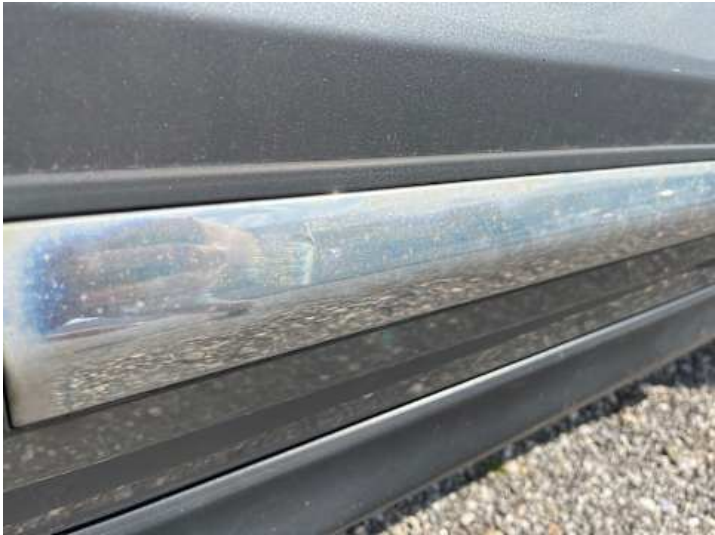
Beifahrtür (Lackschaden, Ausgeblichen/Matt)
