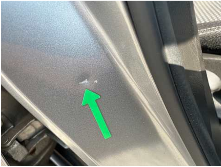
Schweller rechts (Delle, Kratzer)
