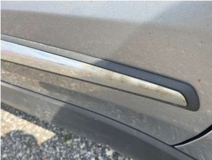
Beifahrtür (Lackschaden, Ausgeblichen/Matt)
