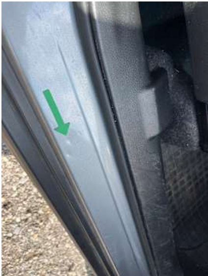
Schweller rechts (Delle, Kratzer)
