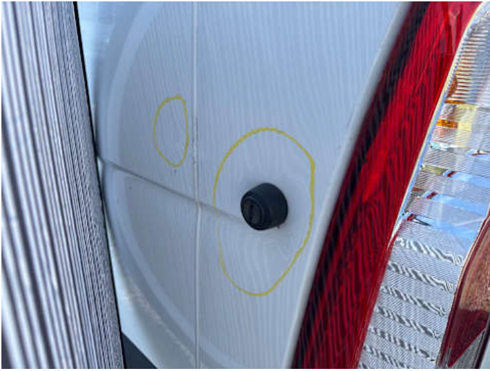
Seitenteil hinten links (Verformung)
