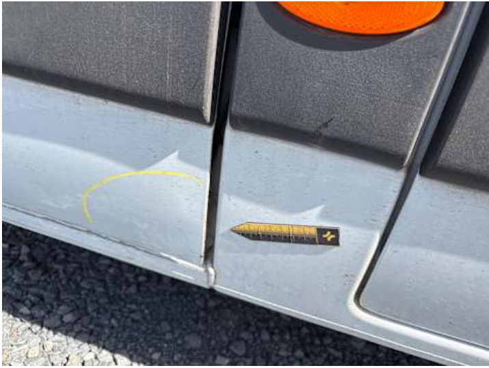
Türe hinten rechts (Spaltmaße ungenau, Verformung)
