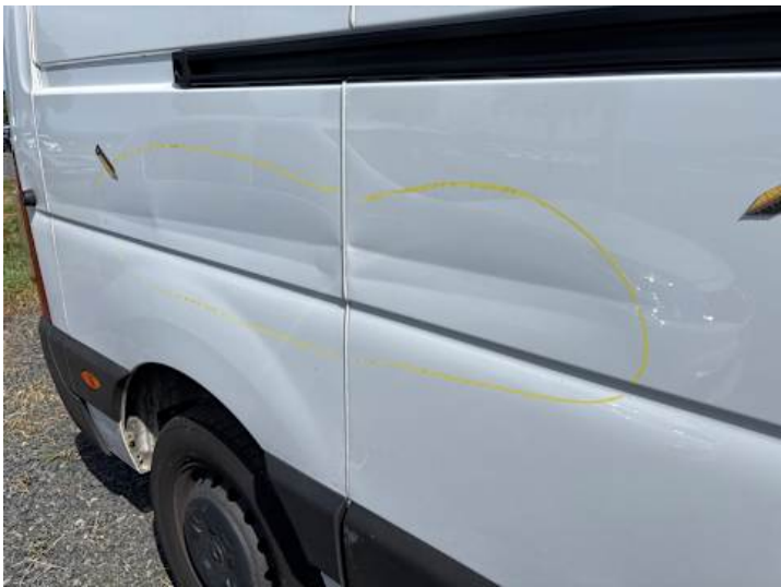
Seitenteil hinten rechts (Verformung)
