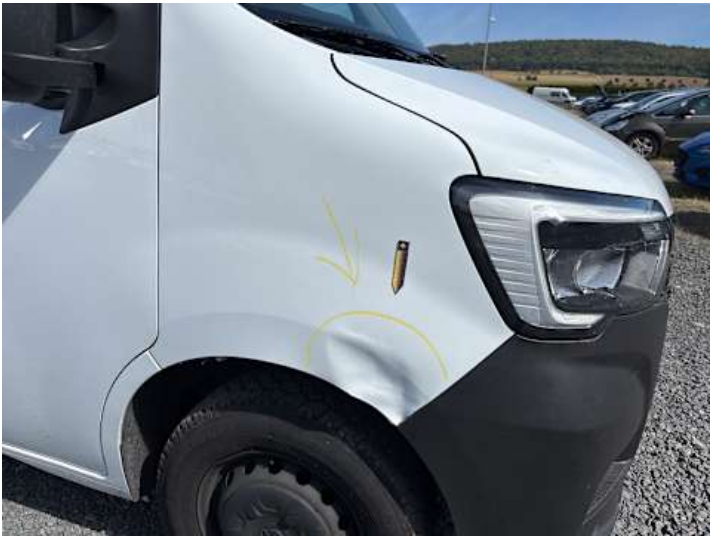
Kotflügel vorne rechts (Verformung)
