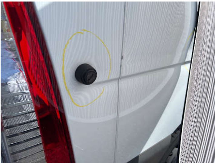
Seitenteil hinten rechts (Verformung)
