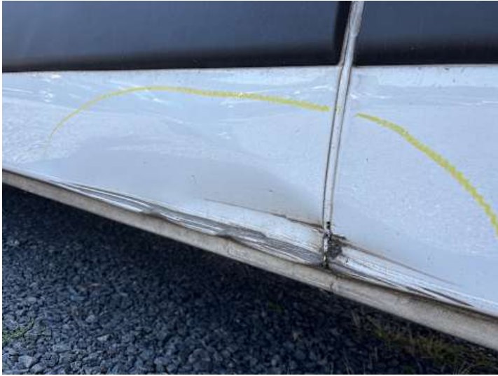
Seitenteil hinten links (Verformung)
