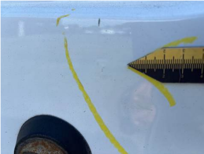
Heckklappe (Rost, Delle)
