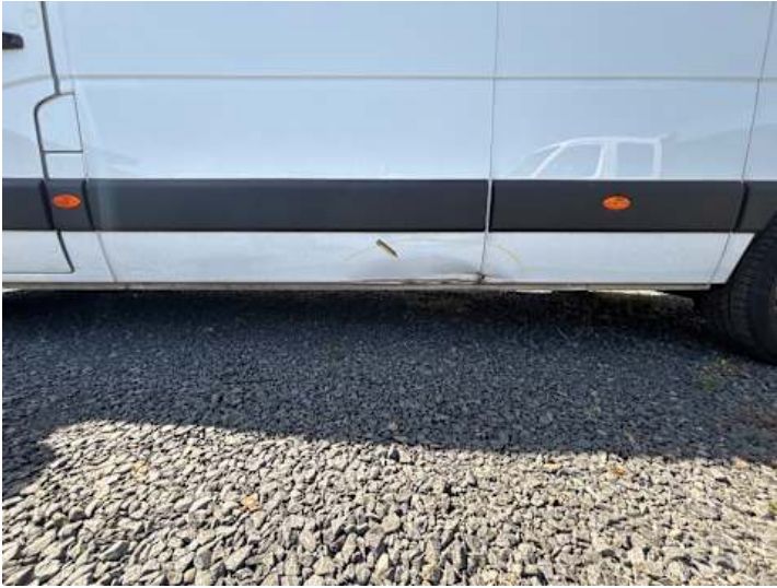
Schweller links (Verformung)
