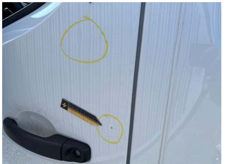
Fahrtür (Kratzer, Delle)
