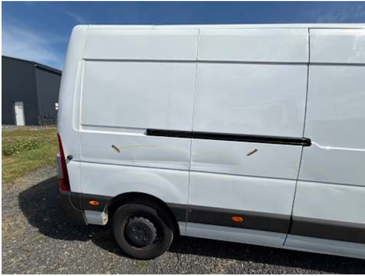
Seitenteil hinten rechts (Verformung)
