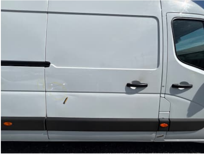
Türe hinten rechts (Spaltmaße ungenau, Verformung)
