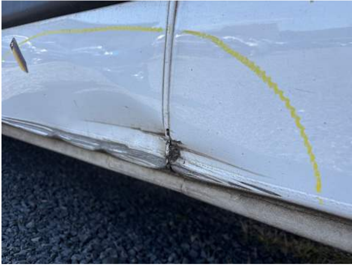
Schweller links (Verformung)
