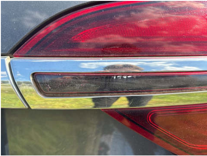
Rücklicht (rechts) (Undicht)
