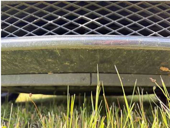
Stoßstange vorne (Riss/Bruch)
