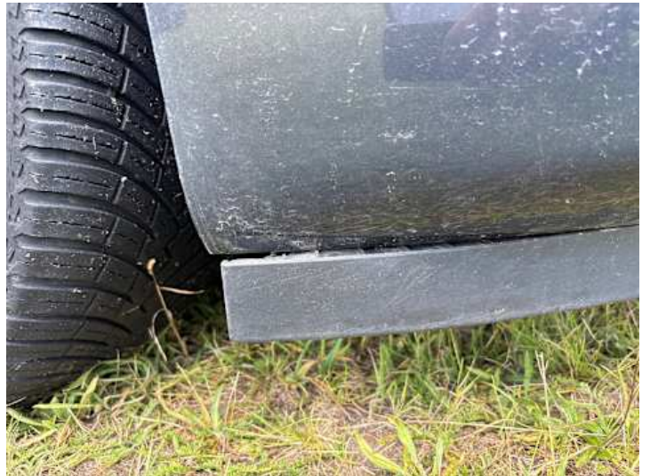
Stoßstange vorne (Riss/Bruch)
