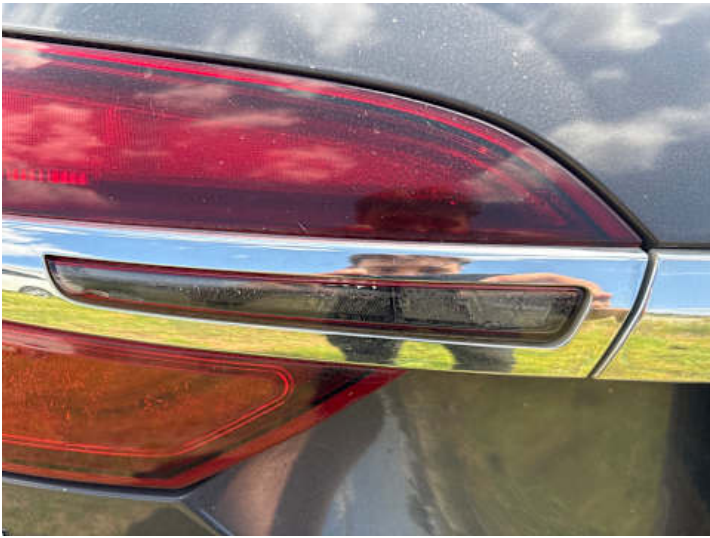
Rücklicht (links) (Undicht)
