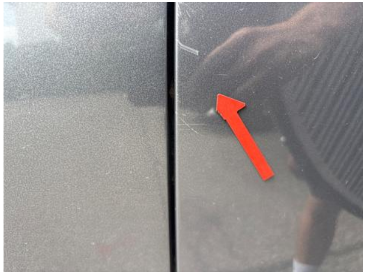
Türe hinten links (Kratzer)
