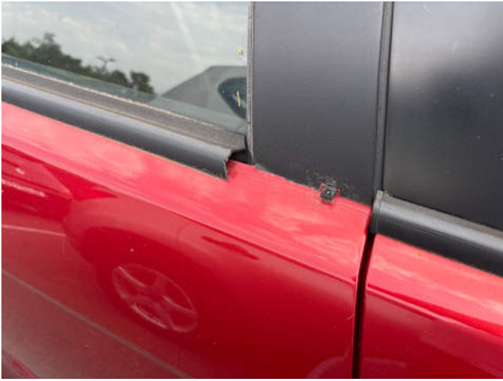
Türe hinten rechts (Riss/Bruch)
