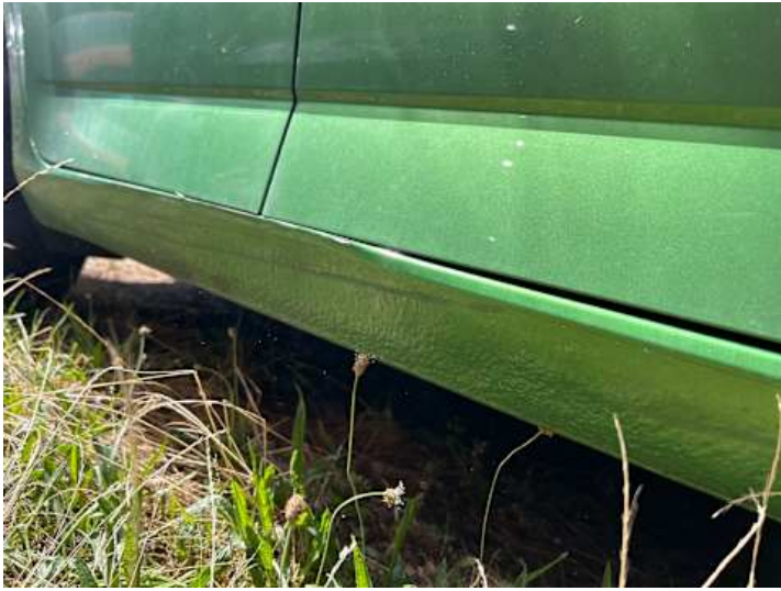
Schweller rechts (Verformung, Lackschaden)
