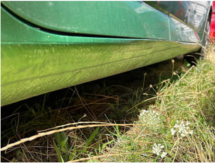
Schweller rechts (Verformung, Lackschaden)
