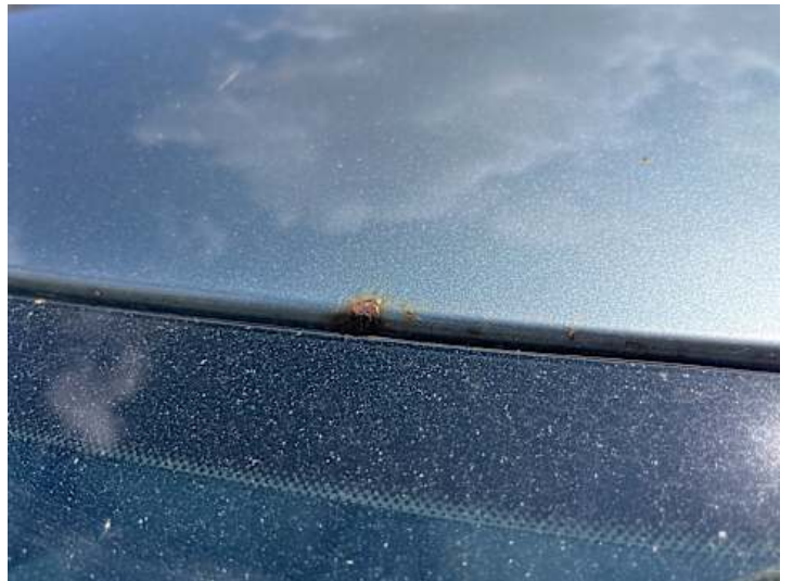
Dach (Lackschaden, Rost)
