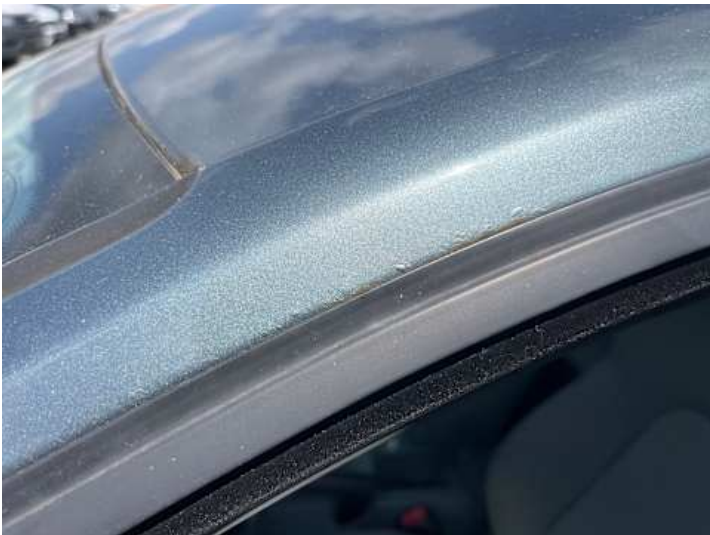
Seitenteil hinten links (Lackschaden, Rost)
