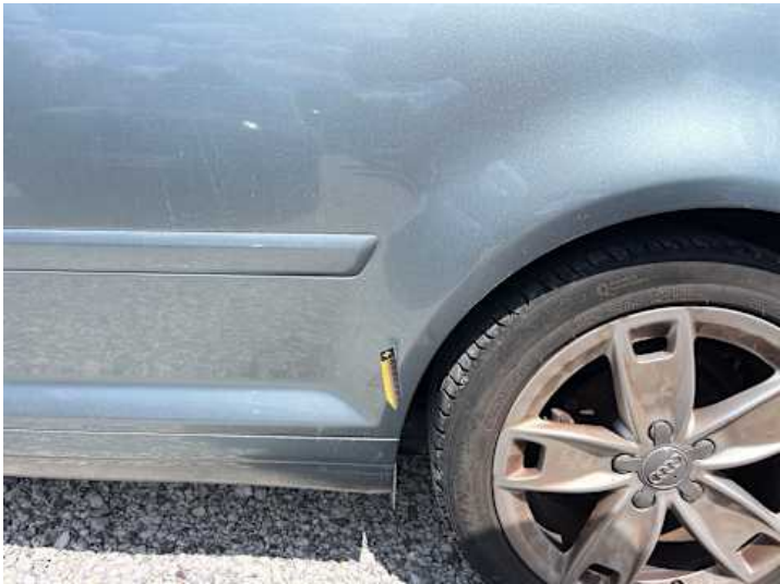
Seitenteil hinten links (Rost, Lackschaden)
