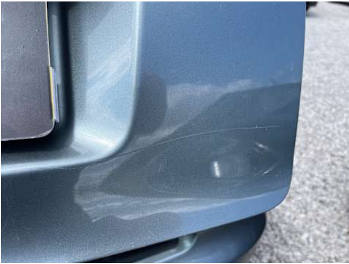
Heckklappe (Rost, Lackschaden, Kratzer)
