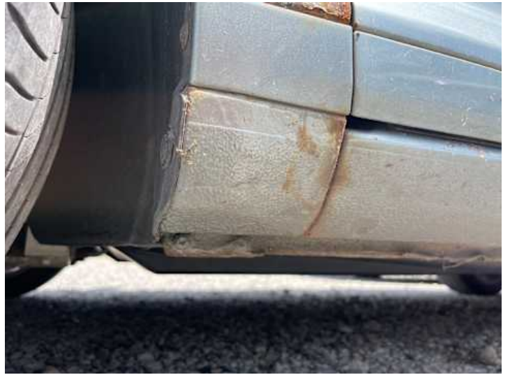
Schweller links (Rost, Lackschaden)
