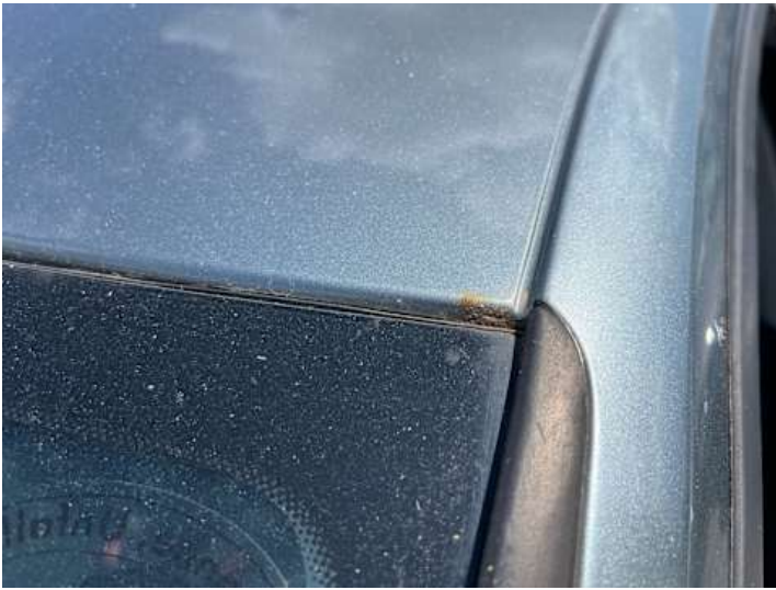
Dach (Lackschaden, Rost)
