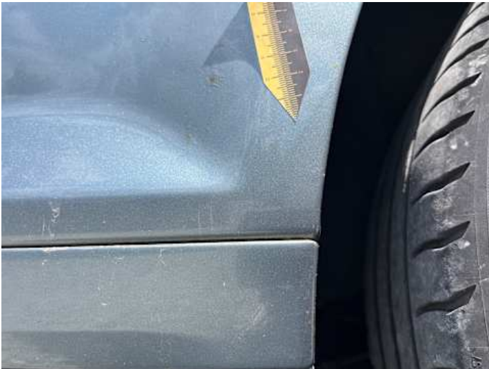
Seitenteil hinten links (Rost, Lackschaden)
