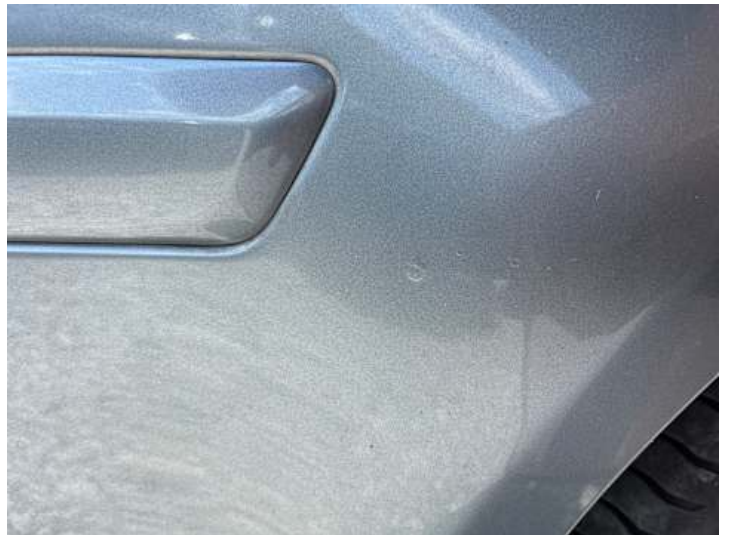
Seitenteil hinten links (Rost, Lackschaden)
