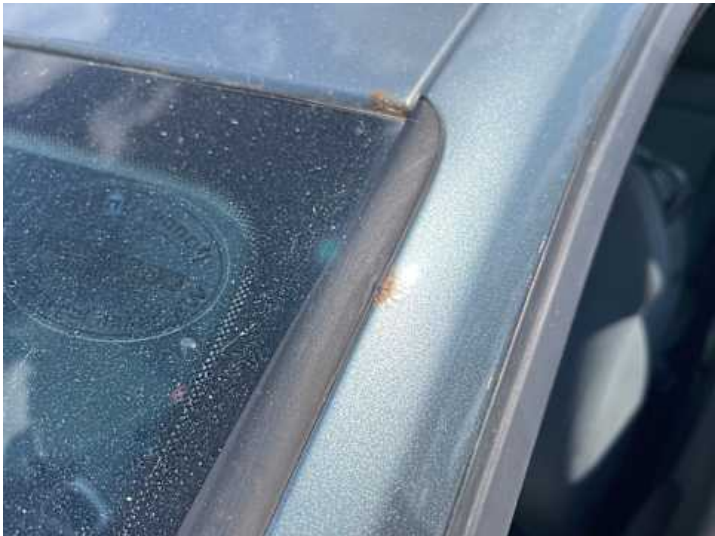
Seitenteil hinten links (Lackschaden, Rost)
