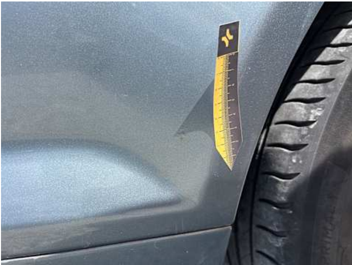
Seitenteil hinten links (Rost, Lackschaden)
