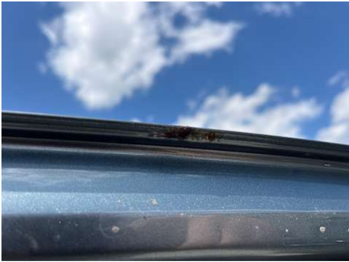
Heckklappe (Rost, Lackschaden, Kratzer)
