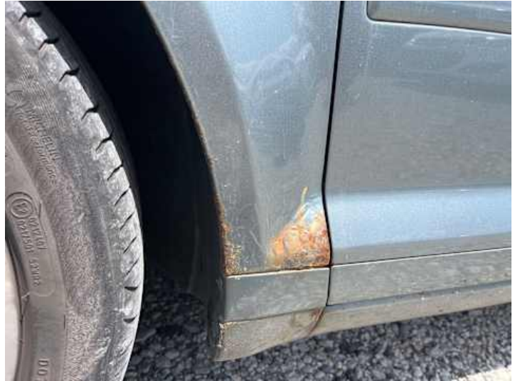
Kotflügel vorne links (Rost, Lackschaden)
