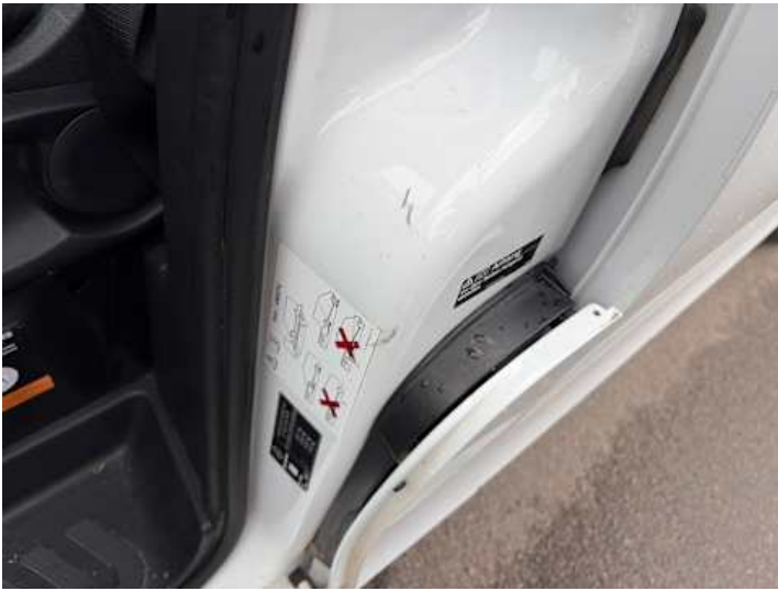
Schweller links (Kratzer, Lackschaden, Delle)
