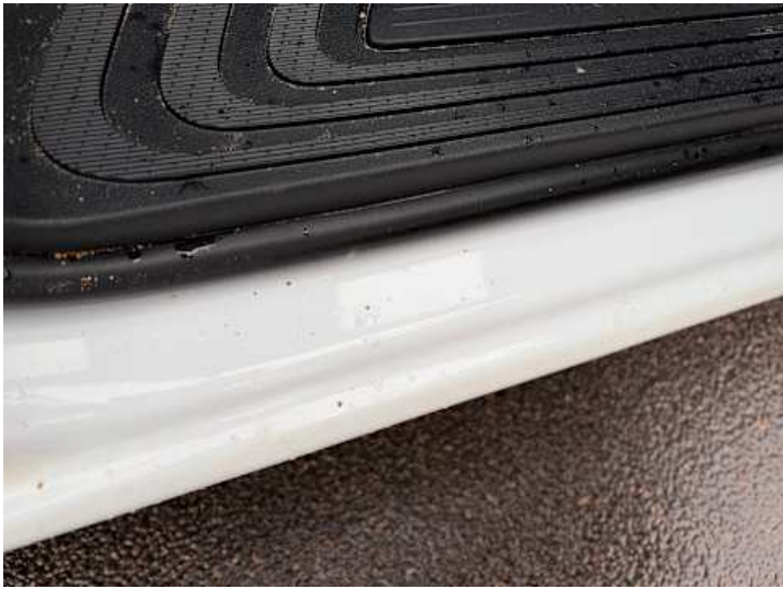
Schweller rechts (Rost, Lackschaden)
