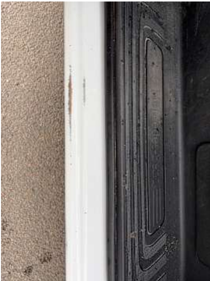
Schweller links (Lackschaden)
