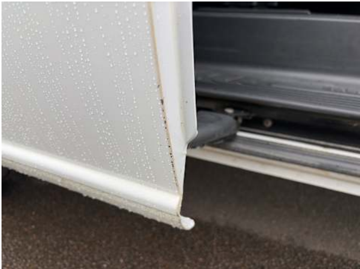
Türe hinten rechts (Lackschaden, Rost)
