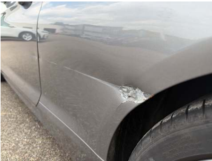
Seitenteil hinten links (Lackschaden, Riss/Bruch)
