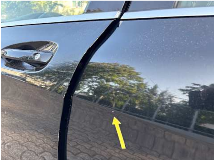
Türe hinten links (Lackschaden)
