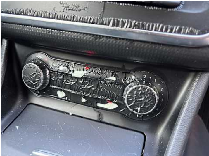
Innenraum (Anderer Schaden): Ablösung Lack
