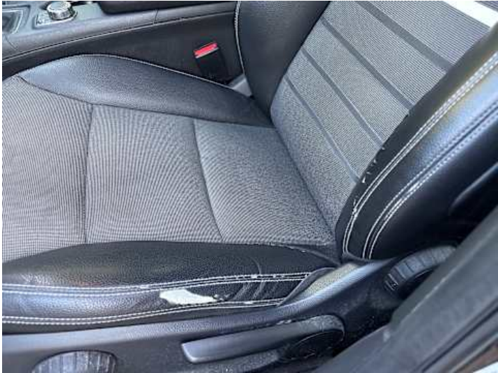
Innenraum (Verschleiß, Riss/Bruch)
