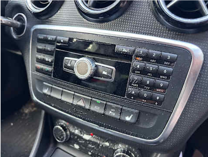
Innenraum (Anderer Schaden): Ablösung Lack
