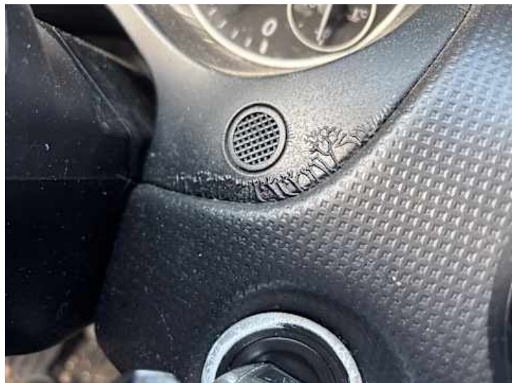
Innenraum (Anderer Schaden): Ablösung Lack
