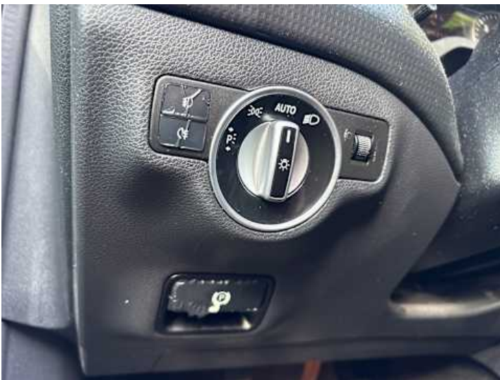
Innenraum (Anderer Schaden): Ablösung Lack
