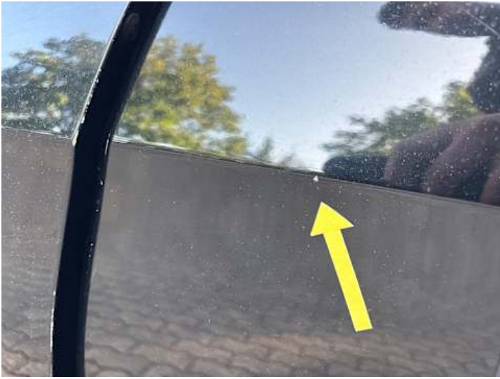
Türe hinten links (Lackschaden)
