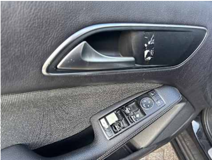
Innenraum (Anderer Schaden): Ablösung Lack
