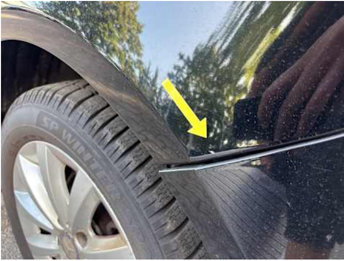
Seitenteil hinten links (Lackschaden)
