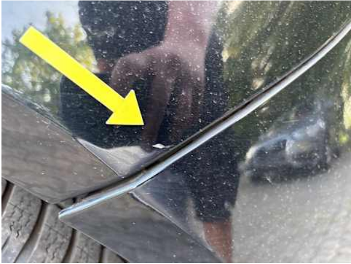
Seitenteil hinten links (Lackschaden)
