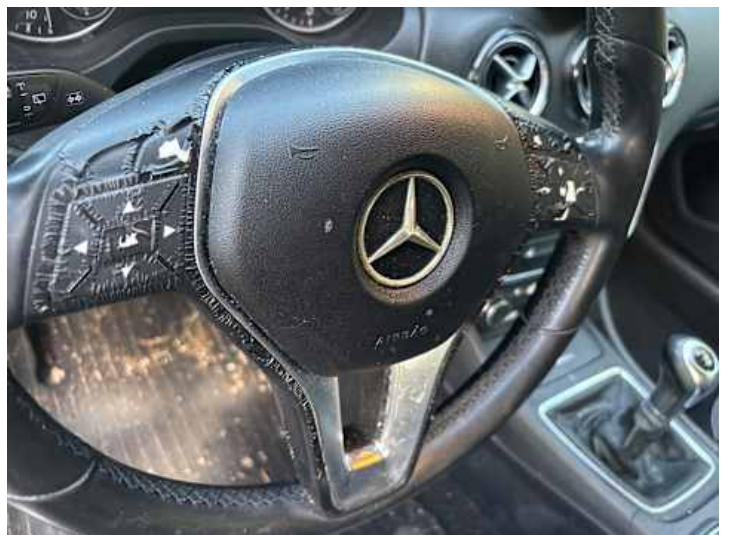
Innenraum (Anderer Schaden): Ablösung Lack
