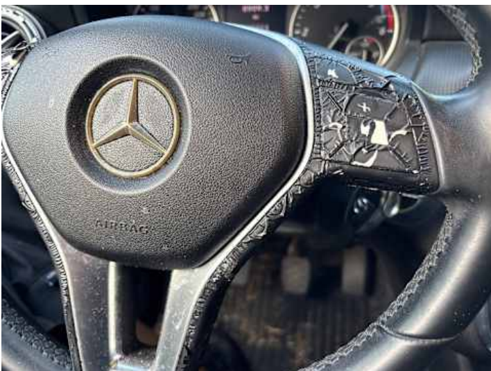
Innenraum (Anderer Schaden): Ablösung Lack
