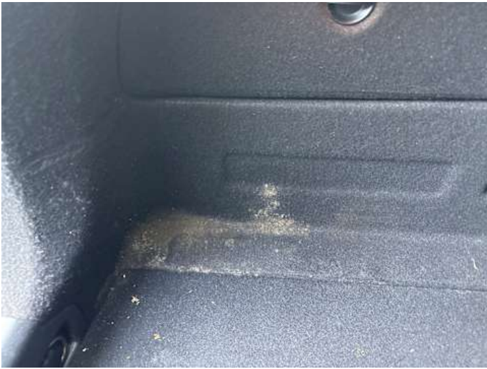
Innenraum (Verschmutzung, Anderer Schaden): Schimmel
