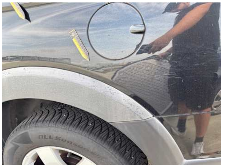
Seitenteil hinten links (Delle, Lackschaden)
