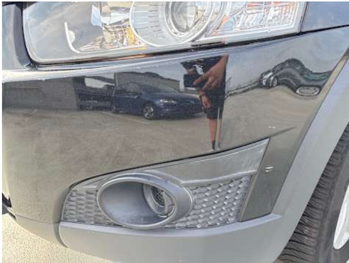
Stoßstange vorne (Lackschaden)
