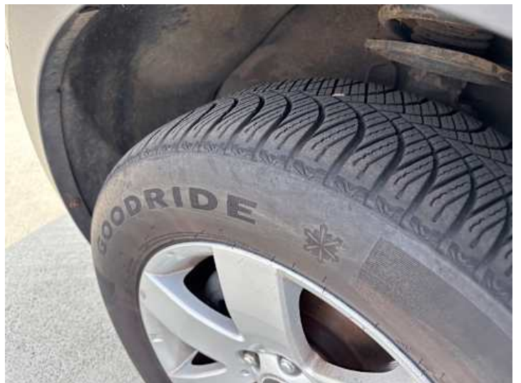
Rad (Ungleichmäßig abgefahren)
