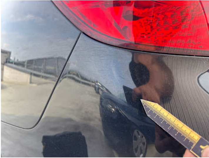
Stoßstange hinten (Lackschaden, Kratzer)
