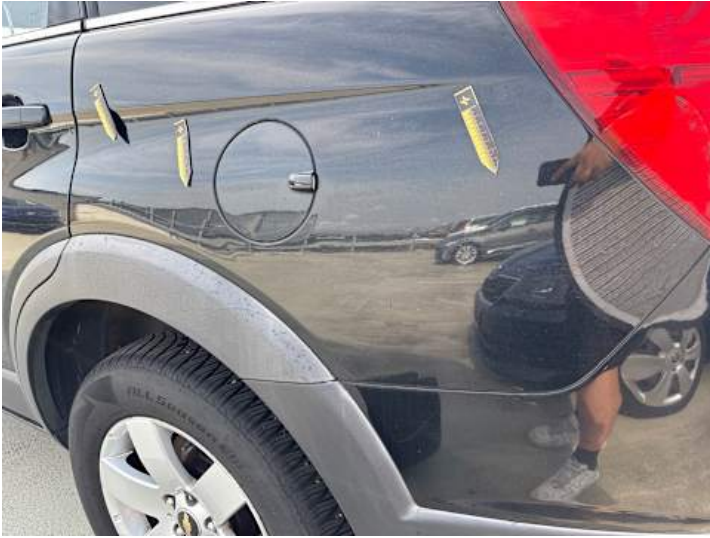
Seitenteil hinten links (Lackschaden, Kratzer)
