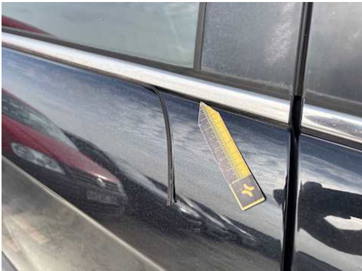
Türe hinten rechts (Riss/Bruch)
