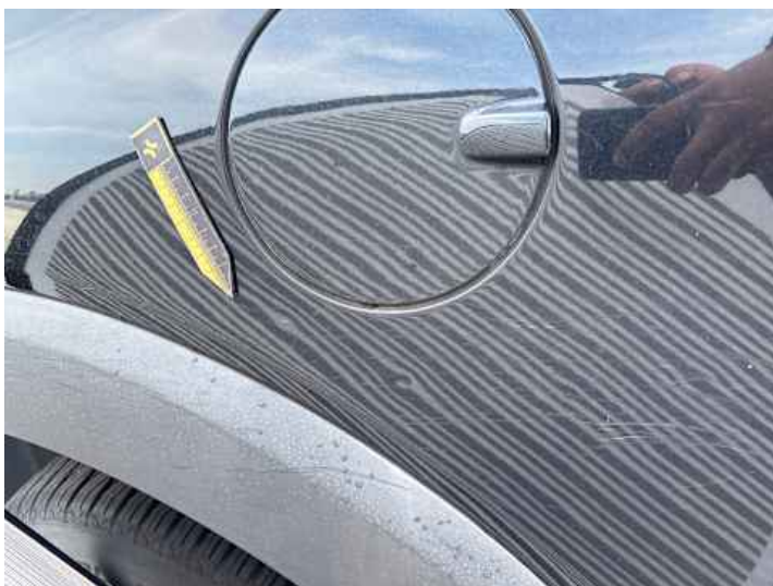
Seitenteil hinten links (Delle, Lackschaden)
