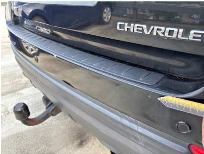
Stoßstange hinten (Lackschaden, Kratzer)
