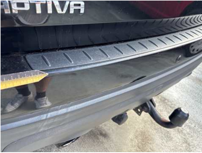
Stoßstange hinten (Lackschaden, Kratzer)
