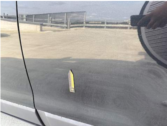
Türe hinten links (Lackschaden)
