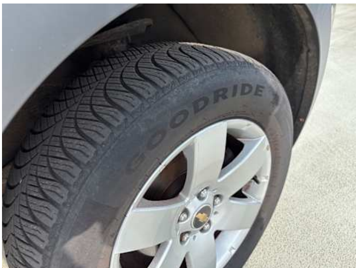
Rad (Ungleichmäßig abgefahren)
