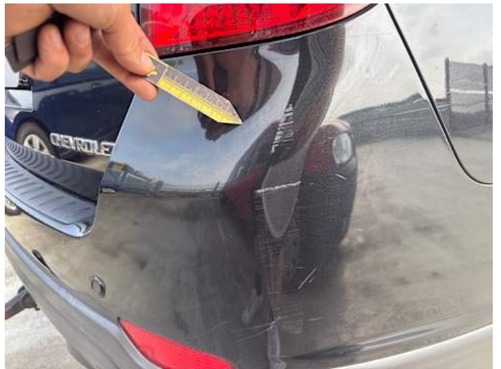
Stoßstange hinten (Lackschaden, Kratzer)
