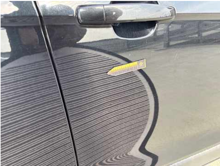
Beifahrtür (Delle, Lackschaden)
