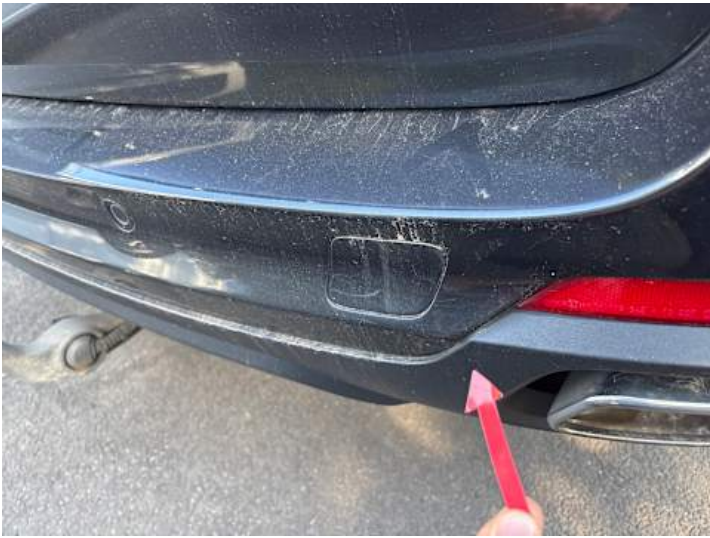
Stoßstange hinten (Riss/Bruch, Lackschaden)
