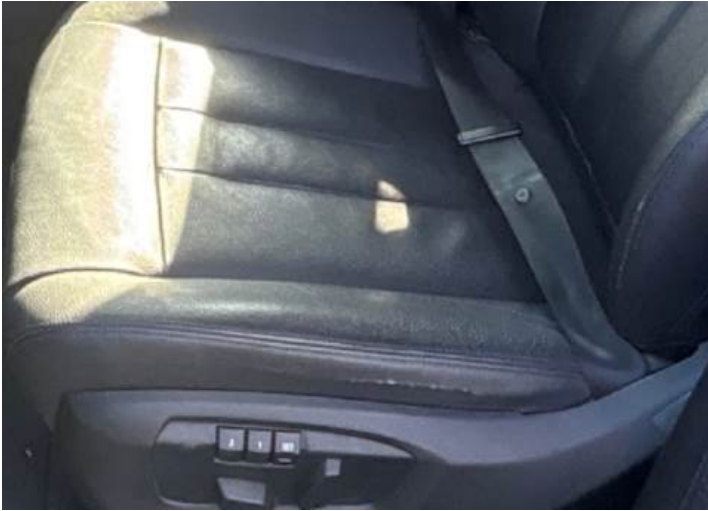
Innenraum (Genereller Schaden, Verschleiß): Riss/Bruch
