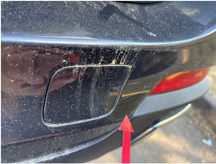
Stoßstange hinten (Riss/Bruch, Lackschaden)
