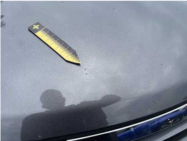
Motorhaube (Steinschlag, Rost)
