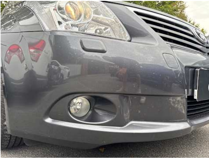
Stoßstange vorne (Kratzer, Steinschlag)
