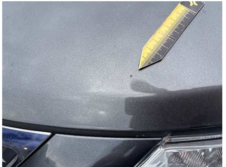
Motorhaube (Steinschlag, Rost)
