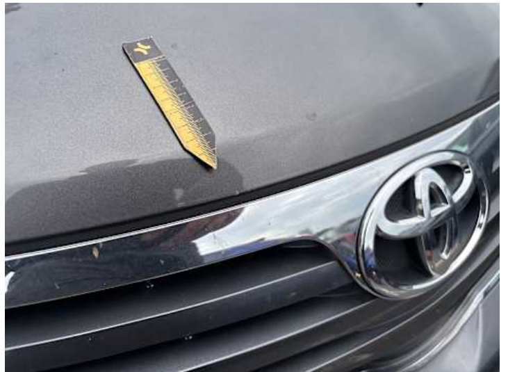
Motorhaube (Steinschlag, Rost)
