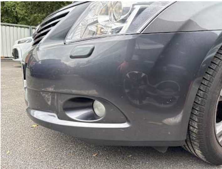
Stoßstange vorne (Kratzer, Steinschlag)
