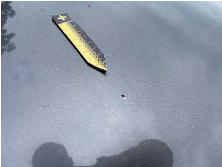
Motorhaube (Steinschlag, Rost)
