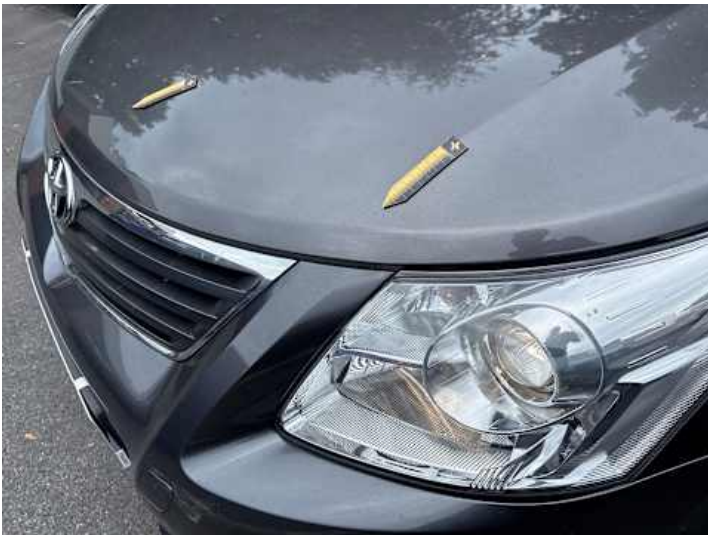
Motorhaube (Steinschlag, Rost)
