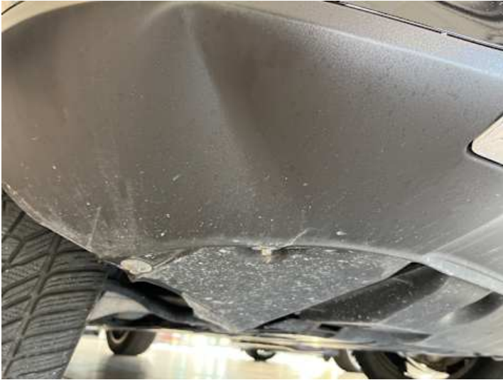
Stoßstange vorne (Kratzer, Verformung)
