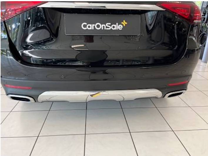
Stoßstange hinten (Riss/Bruch)
