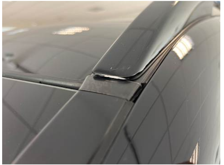
Seitenteil hinten links (Lackschaden, Rost)
