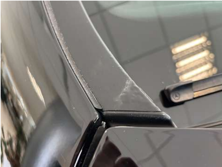
Seitenteil hinten rechts (Lackschaden, Rost)
