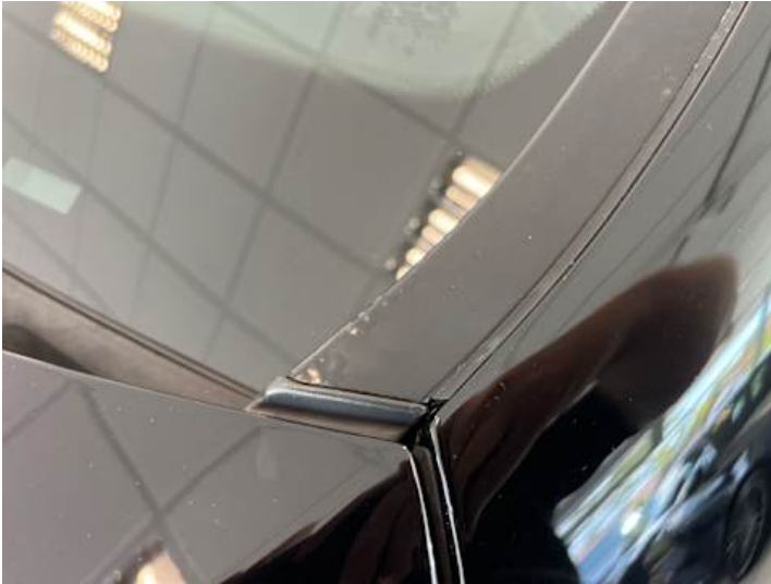
Seitenteil hinten links (Lackschaden, Rost)
