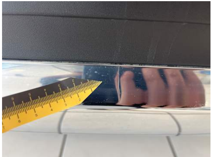
Stoßstange hinten (Riss/Bruch)
