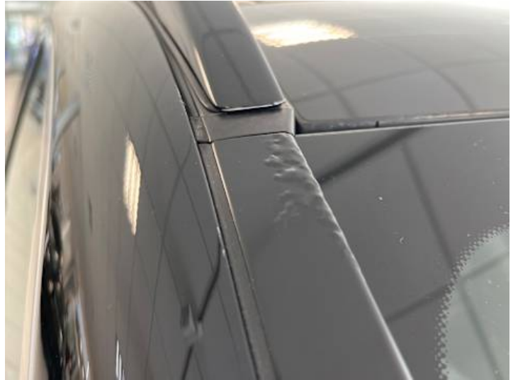
Seitenteil hinten rechts (Lackschaden, Rost)
