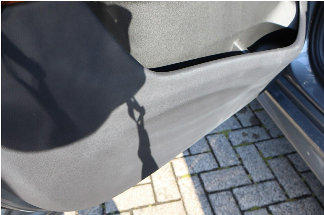
Bild 7 : Innenraum diverse Rückstände von Reinigern
