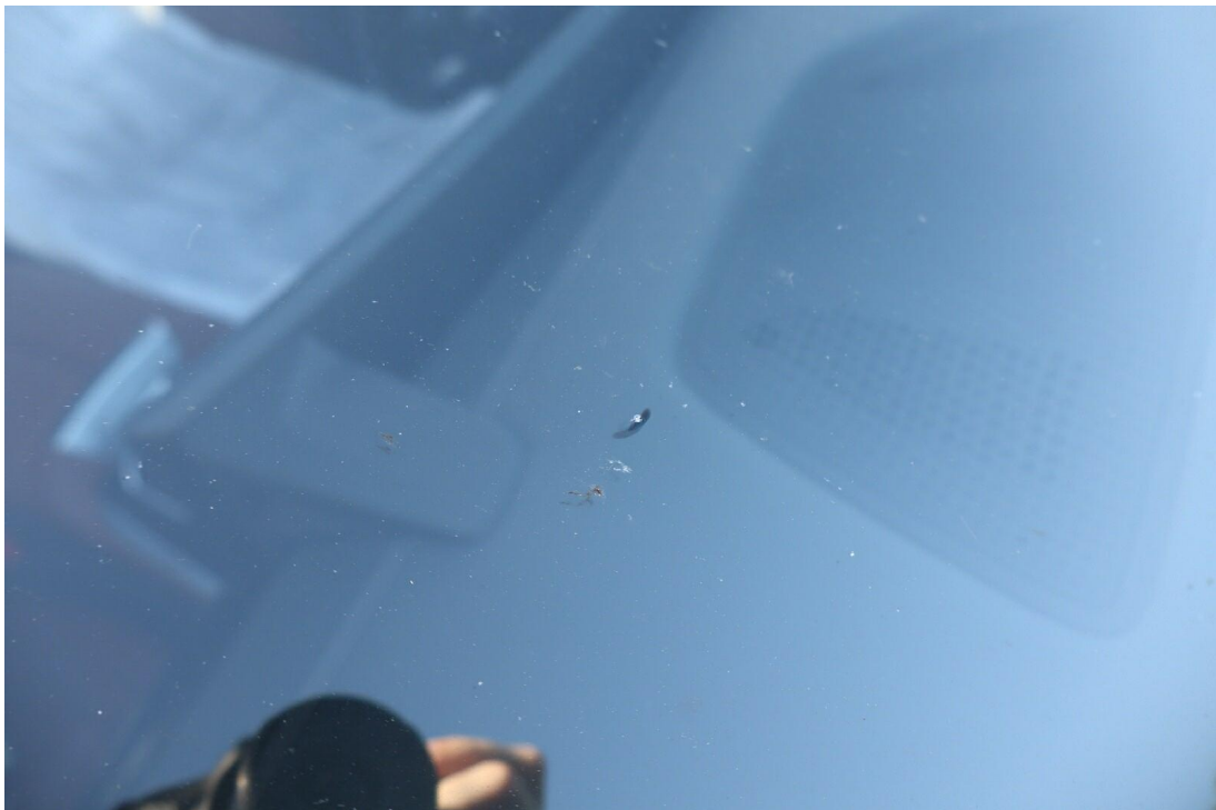
Bild 8 : Windschutzscheibe Steinschlag mit Rissbildung
