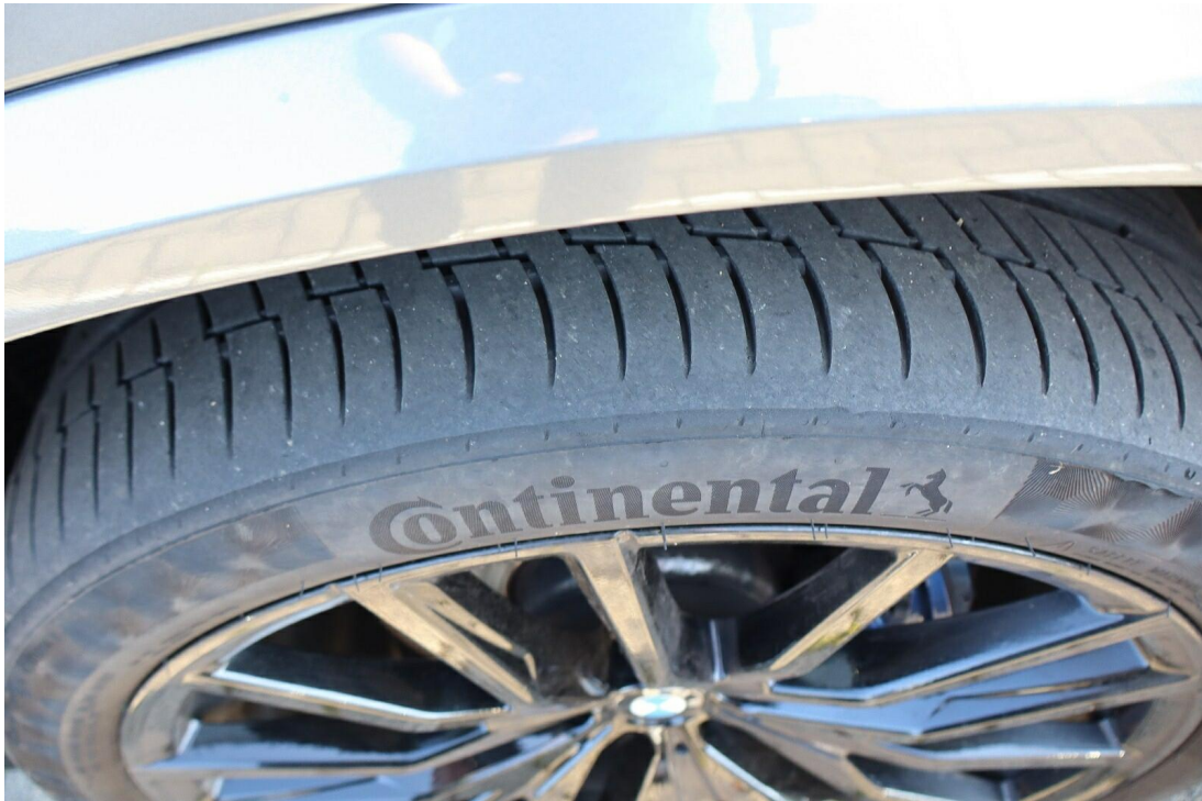
Bild 13 : Reifen vorn stark einseitig abgefahren
