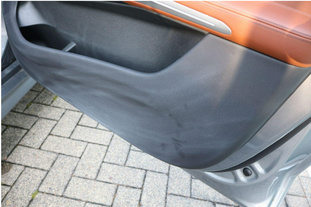
Bild 9 : Innenraum diverse Rückstände von Reinigern
