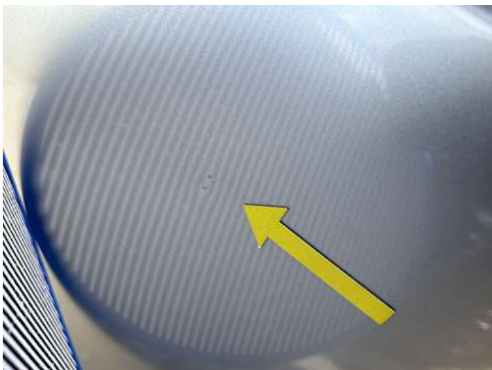
Fahrtür (Delle, Kratzer)
