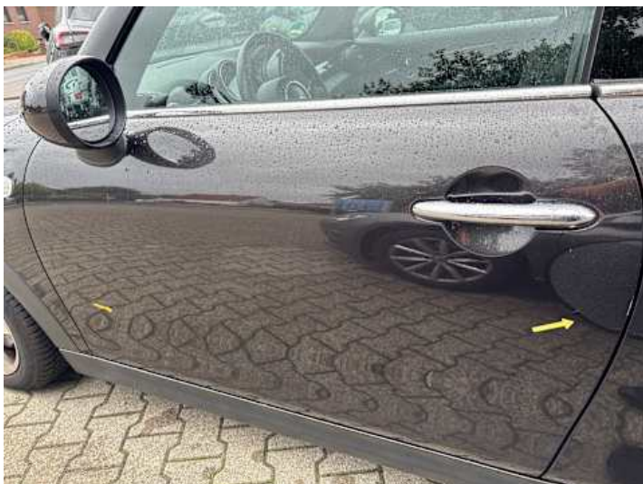
Fahrtür (Kratzer, Delle)
