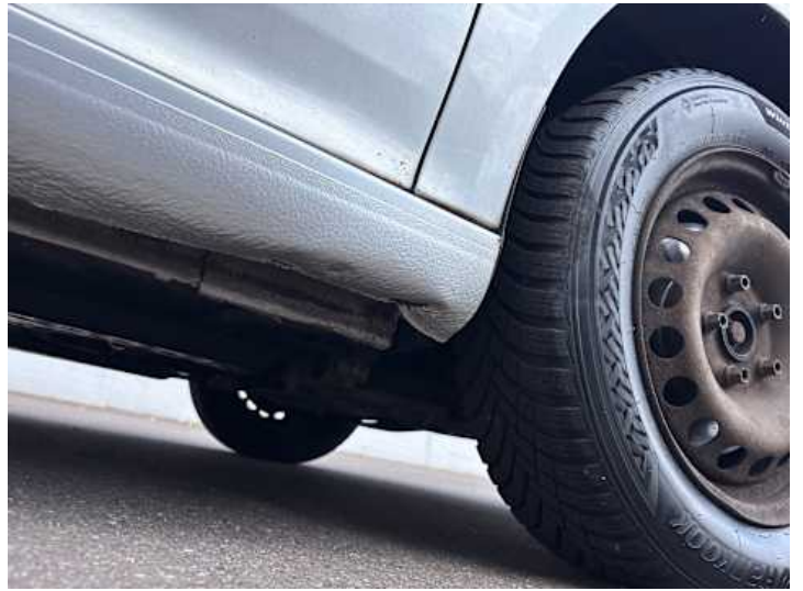
Schweller rechts (Lackschaden, Rost, Verformung)
