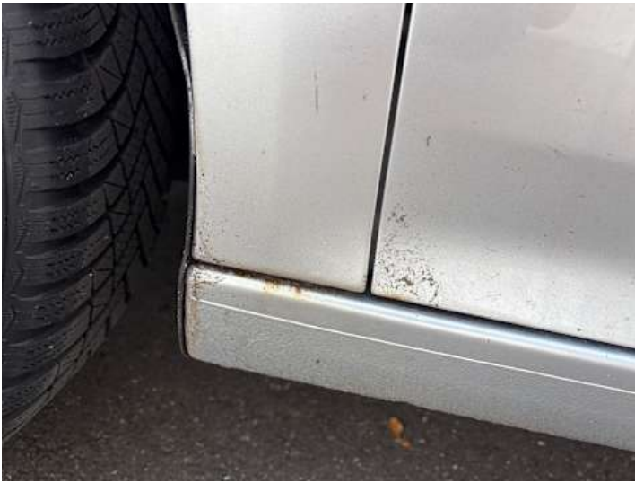
Schweller links (Rost)
