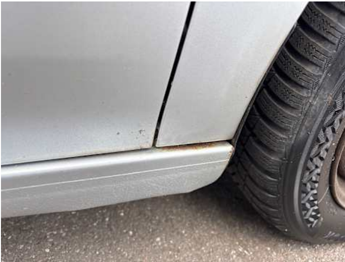
Schweller rechts (Lackschaden, Rost, Verformung)
