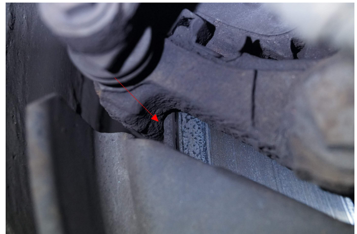
Bild 4: Technik, Bremse hinten - Scheiben, eingelaufen/Rostrand, Gebrauchsspur
