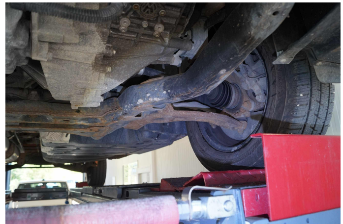
Bild 2: Technik, Bodengruppe und Achsteile, korrodiert, Gebrauchsspur
