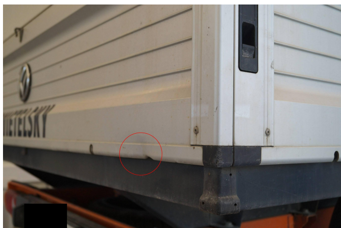
Bild 5: Außen, Bordwand hinten - Bordwand Innen und Hinten, mehrf. eingedellt/verschrammt, Gebrauchsspur
