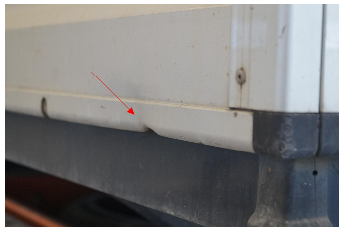
Bild 6: Außen, Bordwand hinten - Bordwand Innen und Hinten, mehrf. eingedellt/verschrammt, Gebrauchsspur
