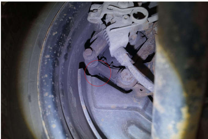
Bild 3: Technik, Bremse hinten - Scheiben, eingelaufen/Rostrand, Gebrauchsspur
