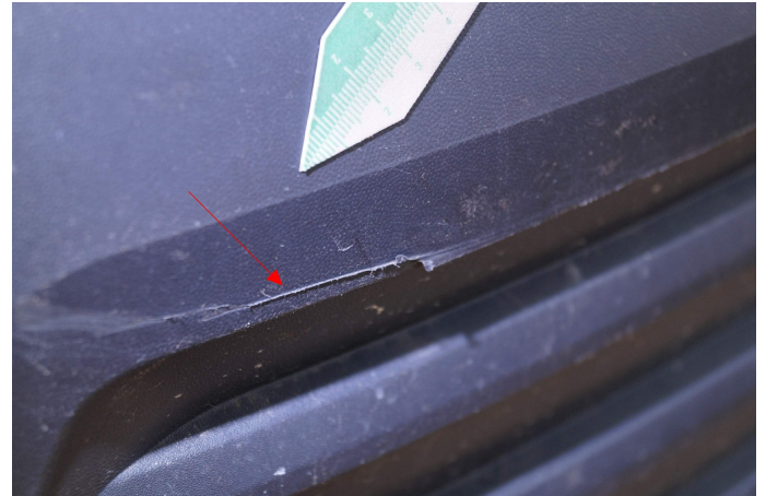
Bild 14: Außen, Stoßfänger vorne rechts, verschrammt, Gebrauchsspur
