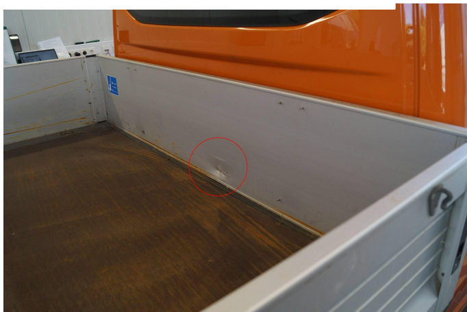
Bild 9: Außen, Bordwand hinten - Bordwand Innen und Hinten, mehrf. eingedellt/verschrammt, Gebrauchsspur
