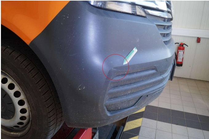
Bild 13: Außen, Stoßfänger vorne rechts, verschrammt, Gebrauchsspur
