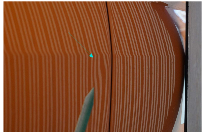
Bild 12: Außen, Tür hinten rechts, mehrfach eingedellt, drücken
