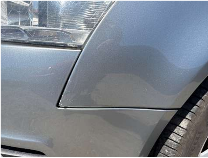
Kotflügel vorne links (Kratzer, Lackschaden)
