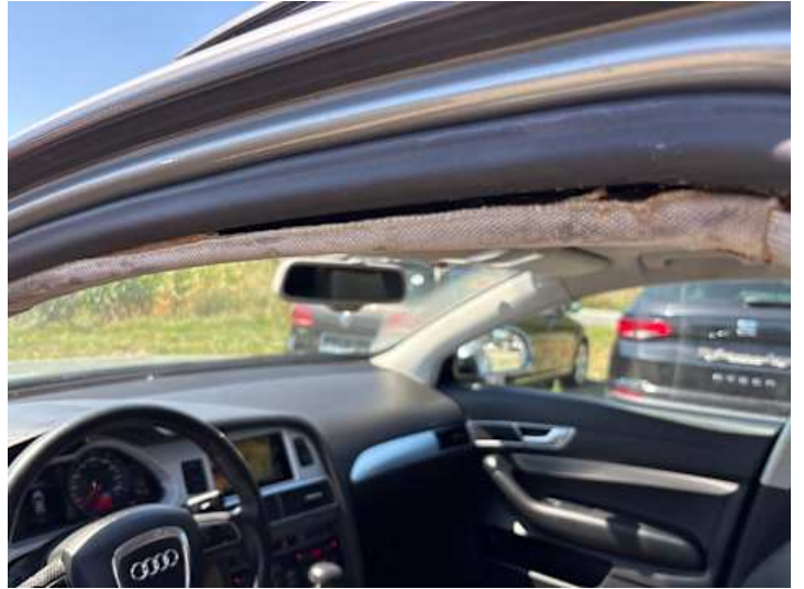
Innenraum (Kratzer, Verschleiß, Riss/Bruch)
