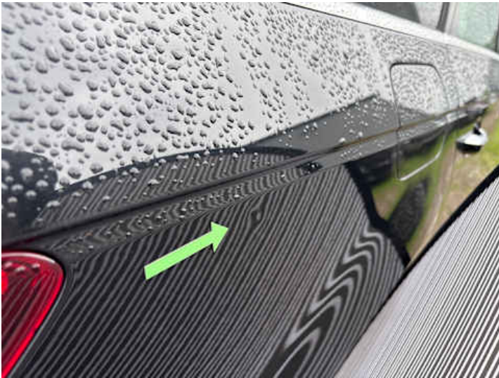
Seitenteil hinten rechts (Delle)
