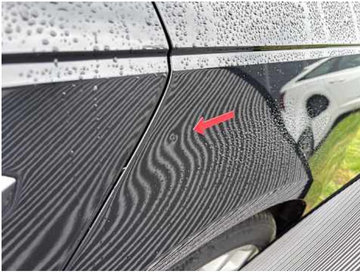
Seitenteil hinten links (Delle)
