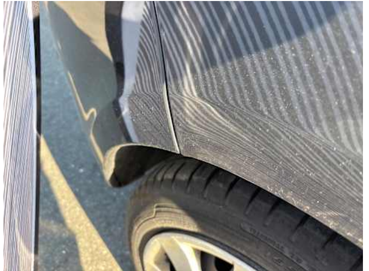
Seitenteil hinten rechts (Verformung)
