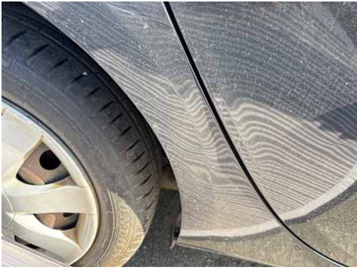
Seitenteil hinten rechts (Verformung, Delle)
