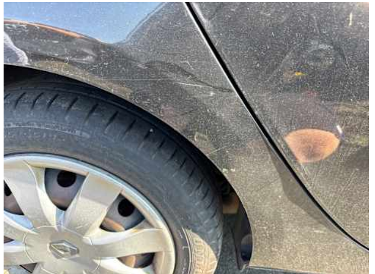
Seitenteil hinten rechts (Kratzer, Spaltmaße ungenau)
