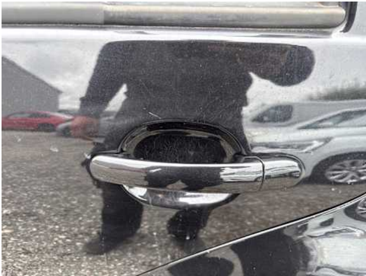
Türe hinten links (Lackschaden, Kratzer)
