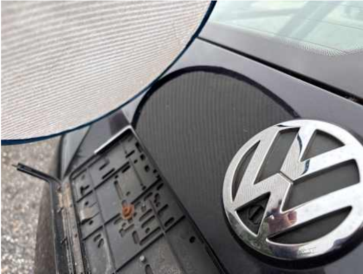
Heckklappe (Rost, Kratzer, Verformung, Delle)
