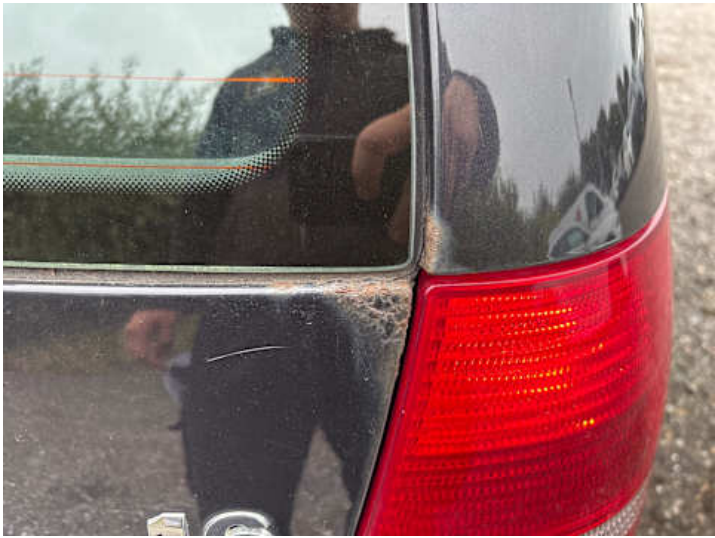
Heckklappe (Rost, Kratzer, Verformung, Delle)
