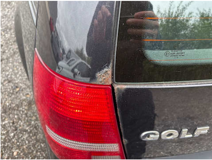
Heckklappe (Rost, Kratzer, Verformung, Delle)
