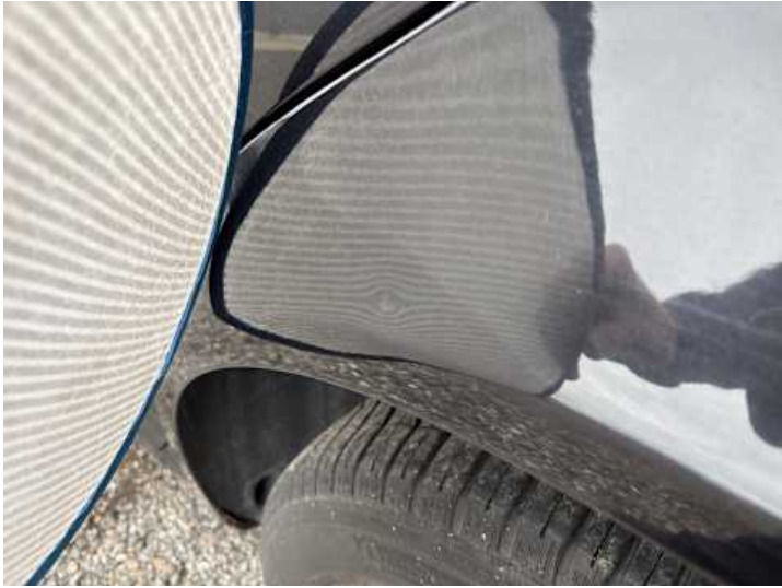
Seitenteil hinten links (Kratzer, Delle)
