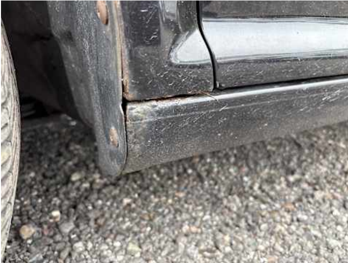
Schweller links (Rost)
