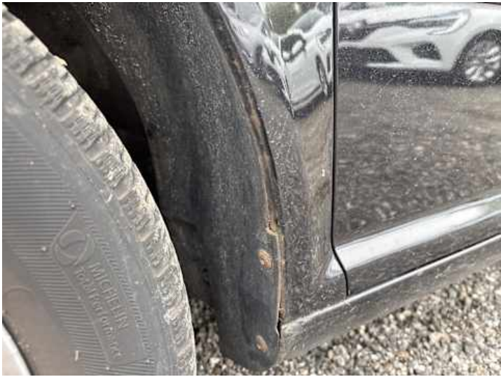
Kotflügel vorne links (Rost, Kratzer)
