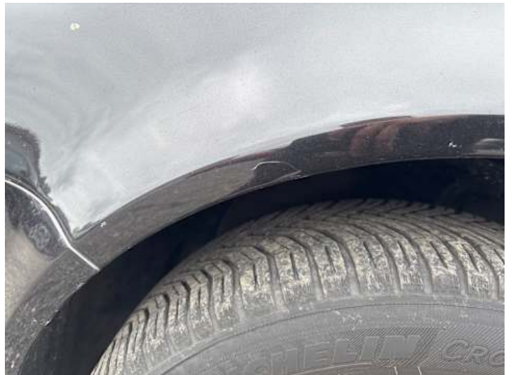
Kotflügel vorne links (Rost, Kratzer)
