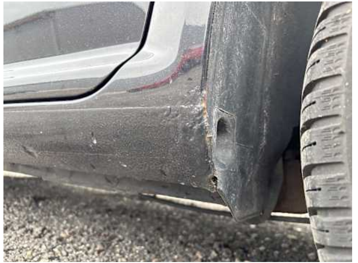
Schweller links (Rost)
