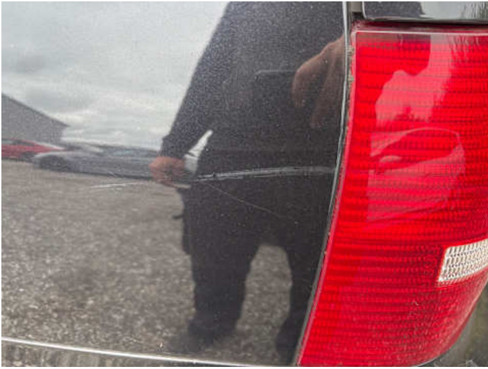
Seitenteil hinten links (Kratzer, Delle)
