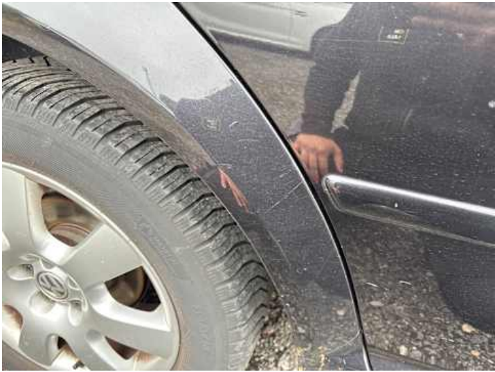
Seitenteil hinten rechts (Kratzer, Lackschaden)
