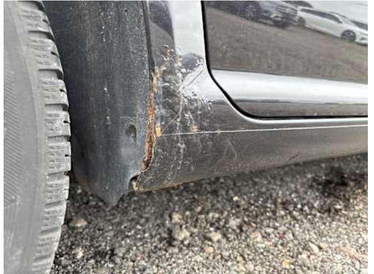
Schweller rechts (Rost)
