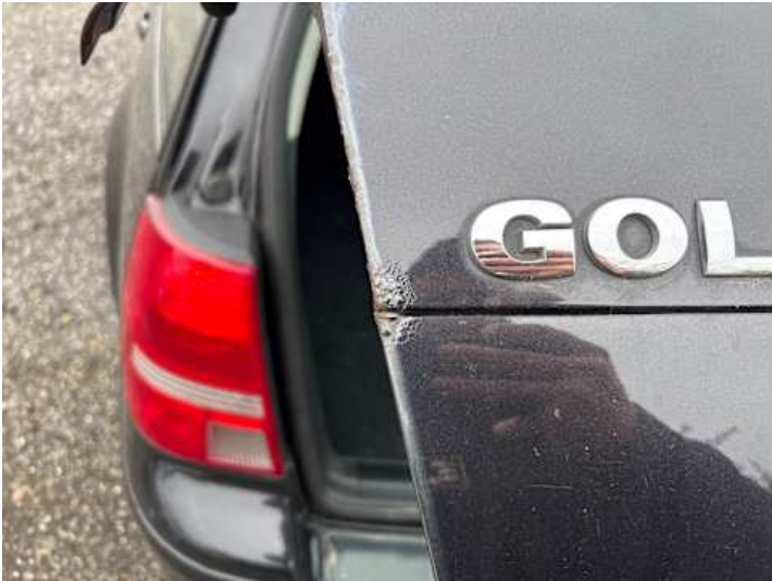
Heckklappe (Rost, Kratzer, Verformung, Delle)
