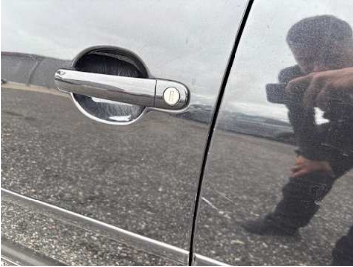
Fahrtür (Lackschaden, Kratzer, Rost)
