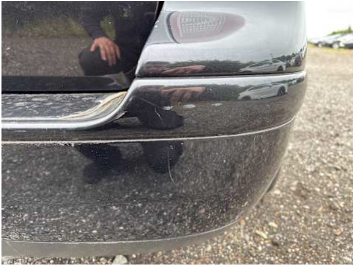
Stoßstange hinten (Lackschaden, Kratzer)
