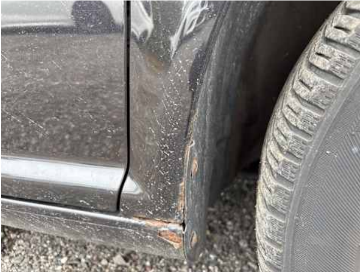
Kotflügel vorne rechts (Rost)
