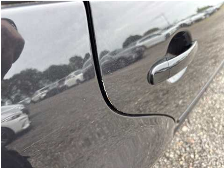
Türe hinten rechts (Lackschaden)
