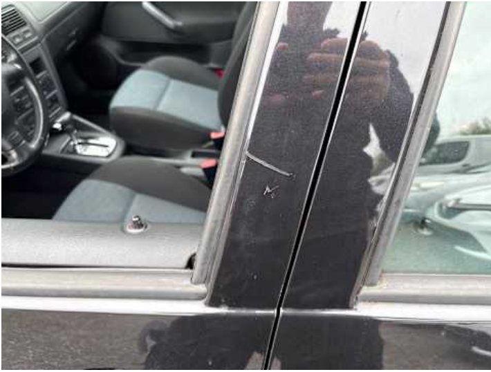
Fahrtür (Lackschaden, Kratzer, Rost)
