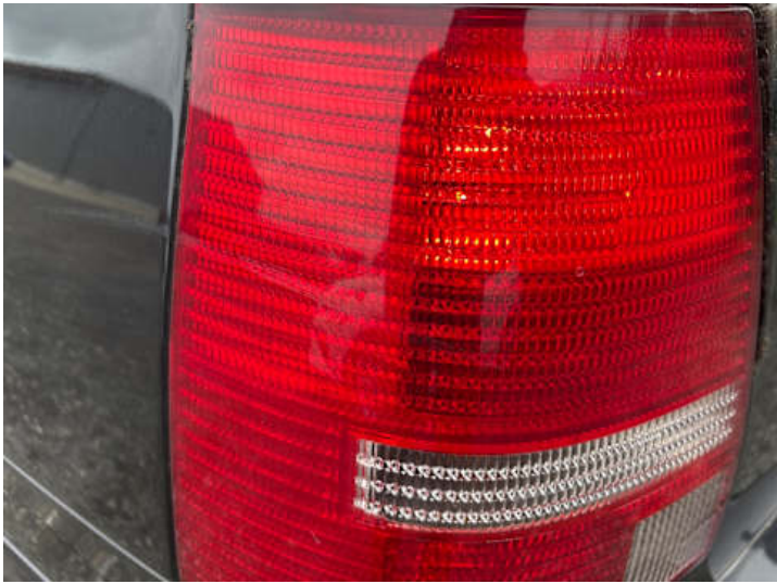
Rücklicht (links) (Riss/Bruch, Kratzer)
