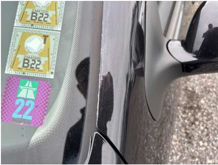
Fahrtür (Lackschaden, Kratzer, Rost)
