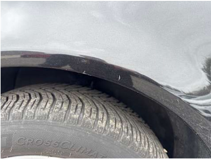
Kotflügel vorne links (Rost, Kratzer)
