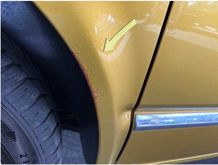
Seitenteil hinten rechts (Rost)
