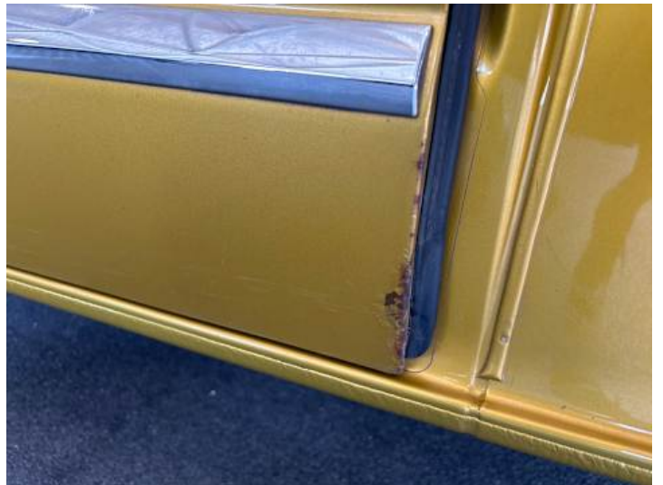
Türe hinten rechts (Rost)
