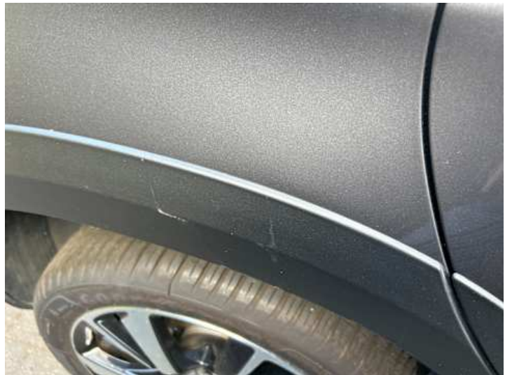
Seitenteil hinten rechts (Kratzer)
