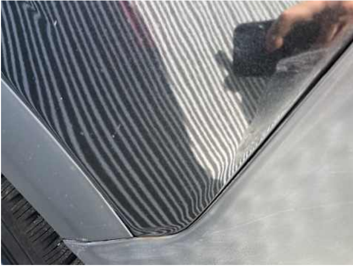
Seitenteil hinten links (Lackschaden, Unsachgemäß instand gesetzt)
