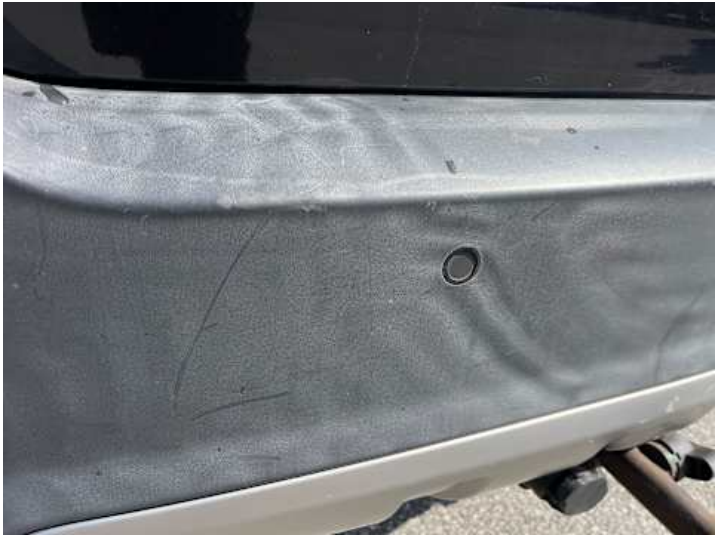
Stoßstange hinten (Kratzer)
