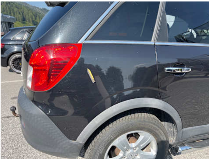
Seitenteil hinten rechts (Kratzer, Lackschaden)
