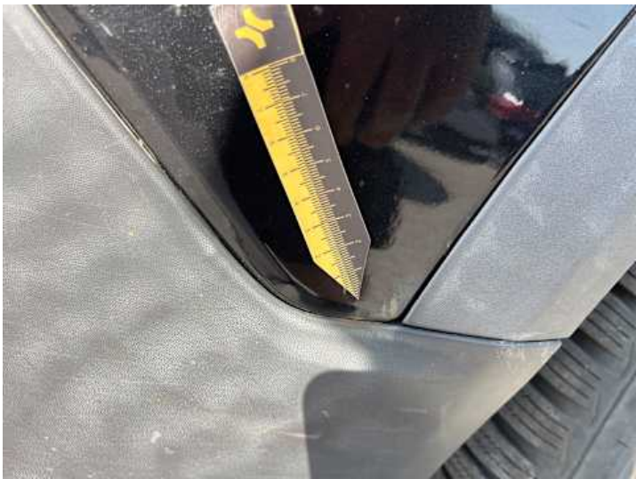
Seitenteil hinten rechts (Lackschaden, Rost)
