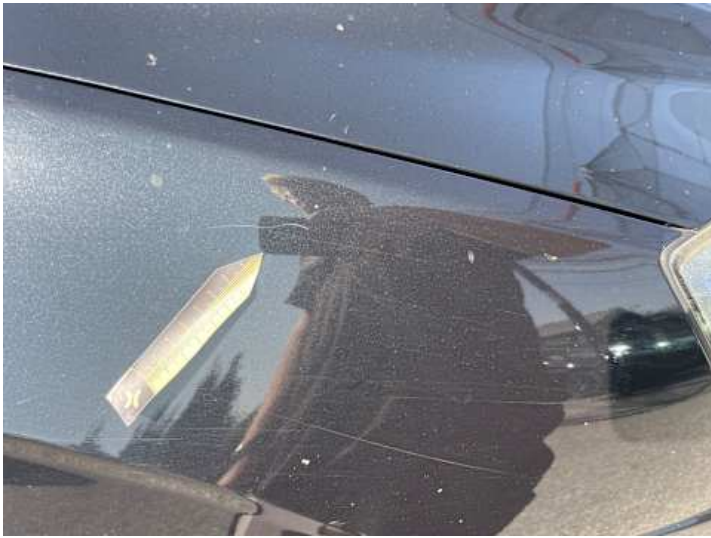
Kotflügel vorne rechts (Kratzer, Lackschaden)
