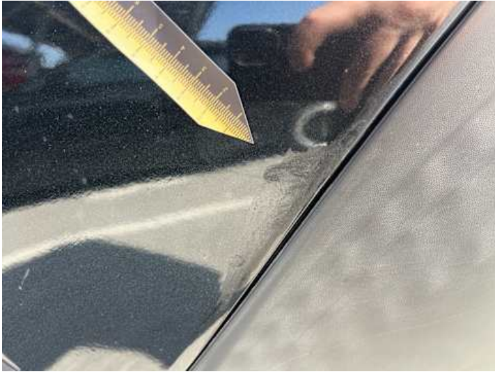
Seitenteil hinten links (Lackschaden, Unsachgemäß instand gesetzt)
