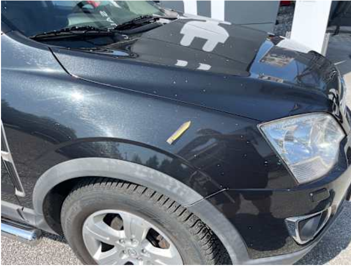
Kotflügel vorne rechts (Kratzer, Lackschaden)
