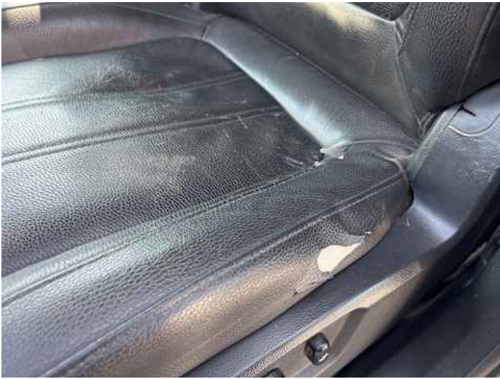
Innenraum (Riss/Bruch, Kratzer)
