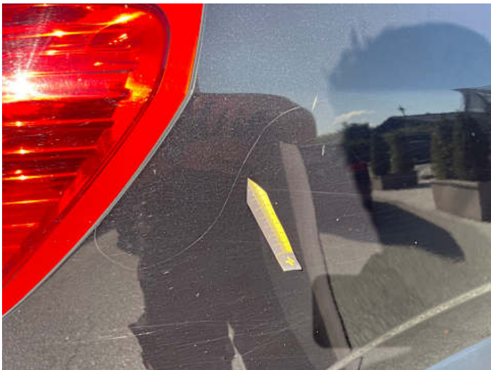
Seitenteil hinten rechts (Kratzer, Lackschaden)
