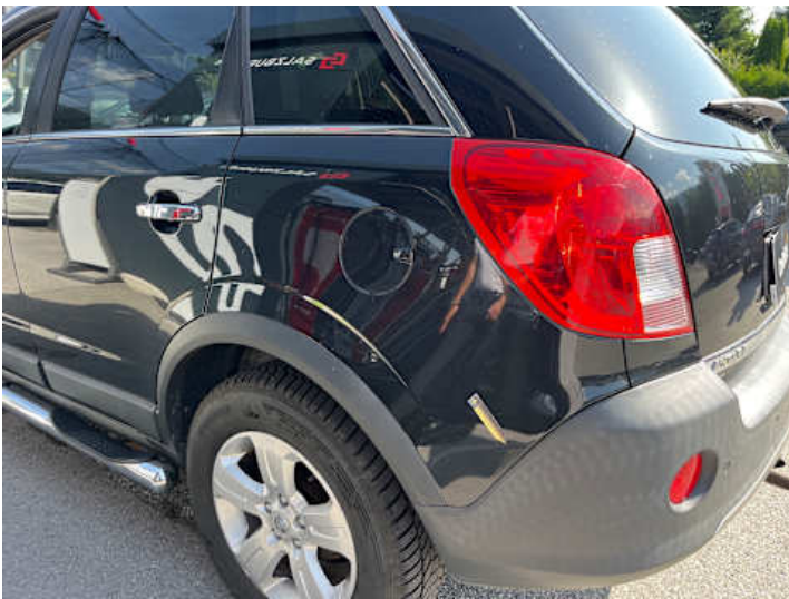
Seitenteil hinten links (Lackschaden, Unsachgemäß instand gesetzt)
