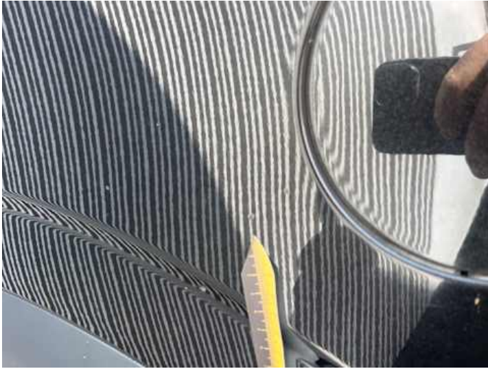
Seitenteil hinten links (Lackschaden, Unsachgemäß instand gesetzt)
