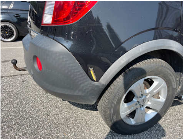
Seitenteil hinten rechts (Lackschaden, Rost)
