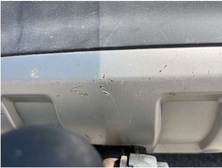
Stoßstange hinten (Kratzer)
