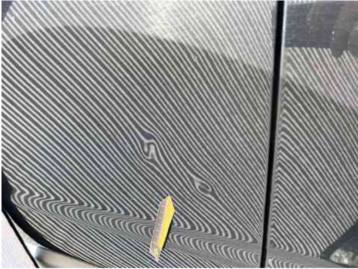
Türe hinten rechts (Delle, Lackschaden, Kratzer)
