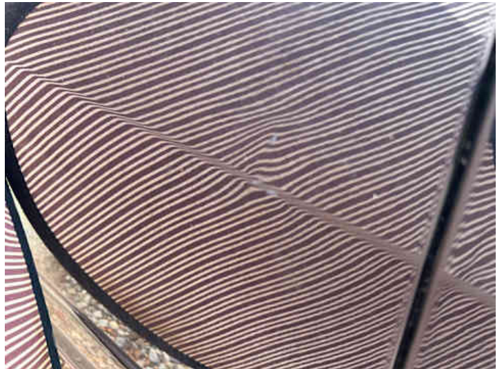
Türe hinten rechts (Delle)
