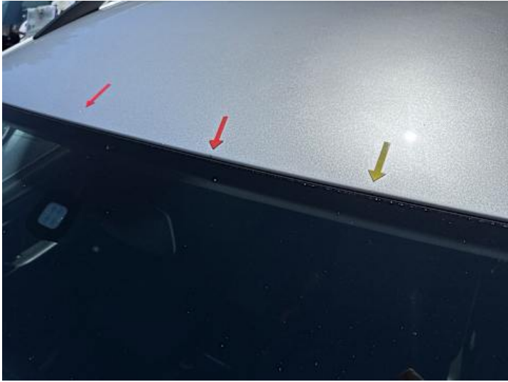
Dach (Lackschaden, Rost, Steinschlag)
