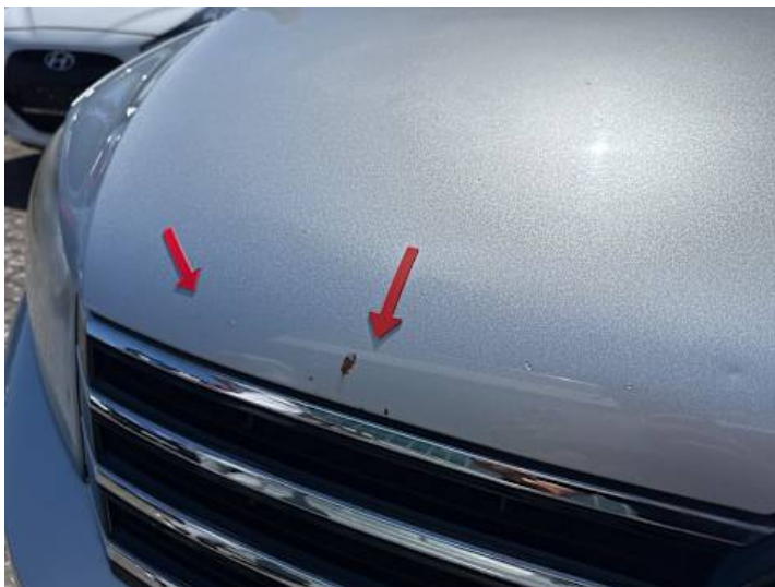
Motorhaube (Lackschaden, Steinschlag, Rost)
