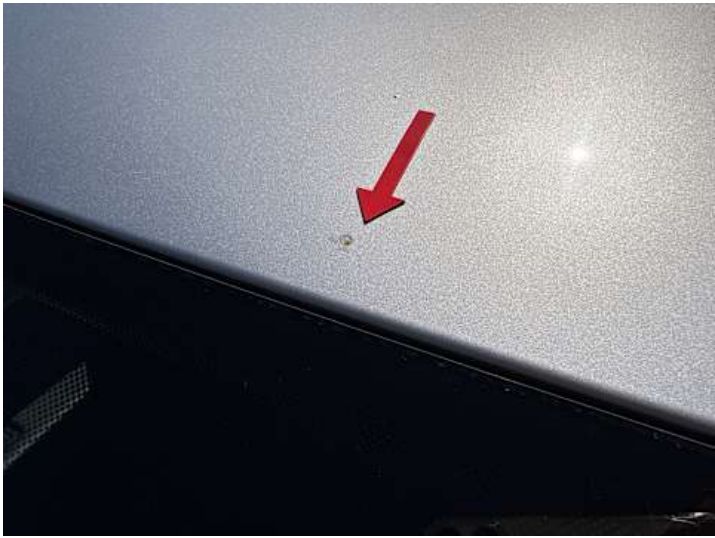
Dach (Lackschaden, Rost, Steinschlag)
