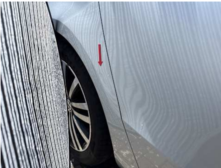
Seitenteil hinten rechts (Verformung)
