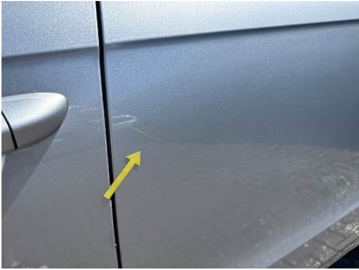
Türe hinten links (Kratzer)
