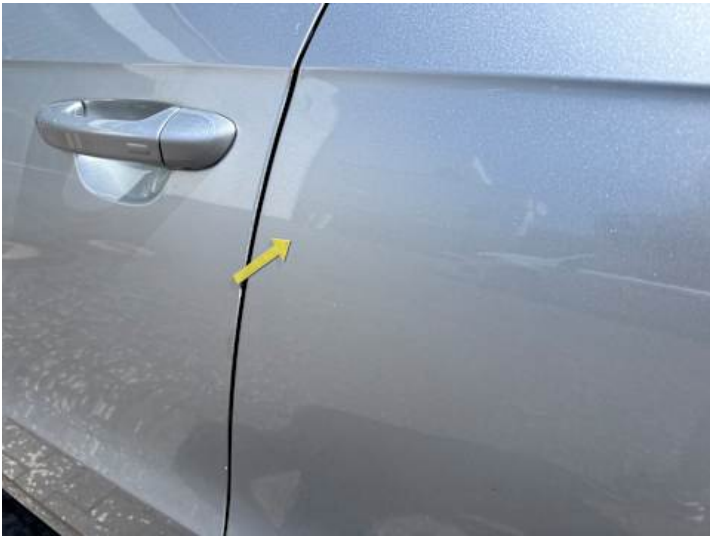
Türe hinten links (Kratzer)
