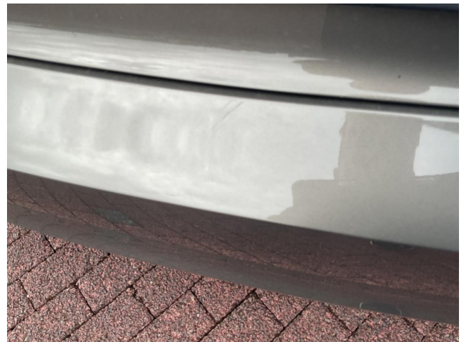
Stoßfänger hinten - nass schleifen/ polieren
